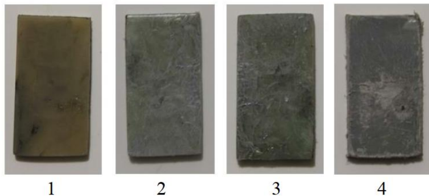
Зразки до дослідження на відносну абразивну стійкість: 1 – Nylon 66; 2 – Nylon 66(5); 3 – Nylon
