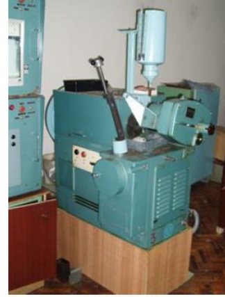
Машинка СМЦ-2 та схема для дослідження на абразивне зношування
