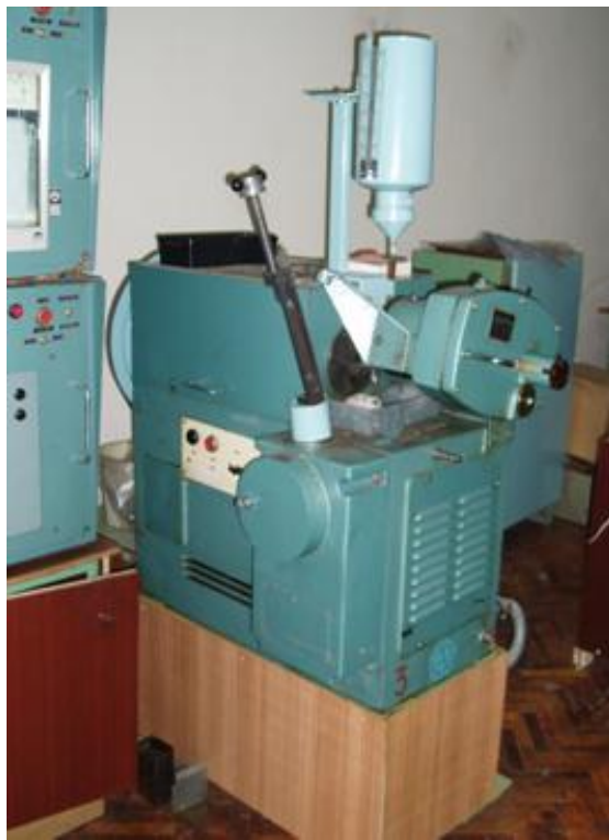
Рисунок 2.6 – Машина тертя СМЦ-2 (а) та схема реалізації процесу абразивного зношування (б): 1 – гумовий ролик; 2 – абразивний матеріал; 3 – механізм створення навантаження; 4 – зразок матеріалу, що досліджується
