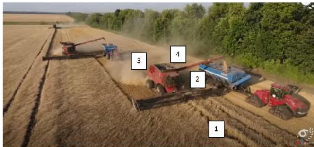
Рис.4.1. Небезпечні зони і фактори при збиранні пшениці ярої: 1 – перед робочими органами працюючої техніки; 2 – в зоні між двома енергетичними засобами; 3 – позаду машини; 4 – фактор підвищеної запліненості.
