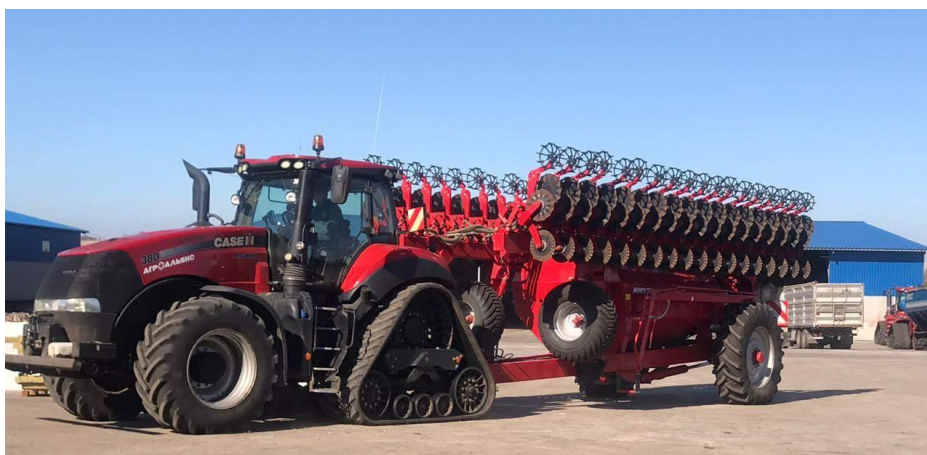
Рис.1.1. Агрегат Case MX 380 + Horcsh Maestro 36.5, що використовується в технологіях No-till та Strip-till.
