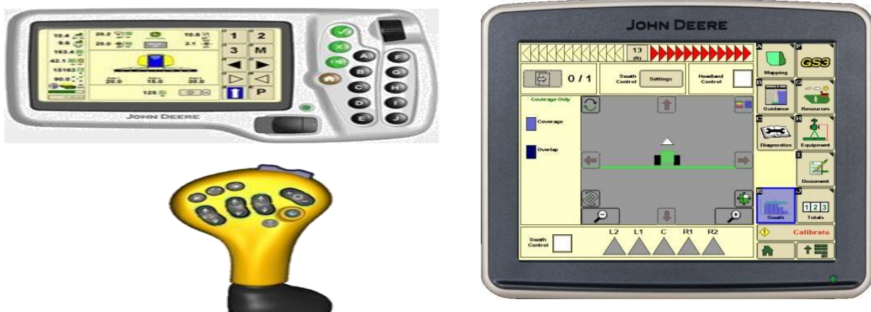
Рис.2.4. Монітори моделей 1800 та 2630, виробництва John Deere.
