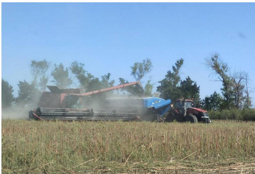
Рис.1.1. Момент вивантаження насіння соняшника в бункер-перевантажувач. Наступним етапом буде перевантаження насіння в автомобіль на краю поля.
