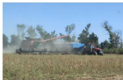
Вивантаження на ходу: 12500 літрів за 2 хвилини.
