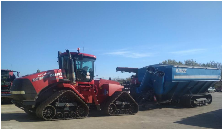
Рис.1.3. Агрегат у складі трактора Case IH Quadtrack 600 і бункера-перевантажувача Kinze-1350 призначений для збирання зерна від комбайнів, транспортування на край поля і перевантаження в автомобілі.
