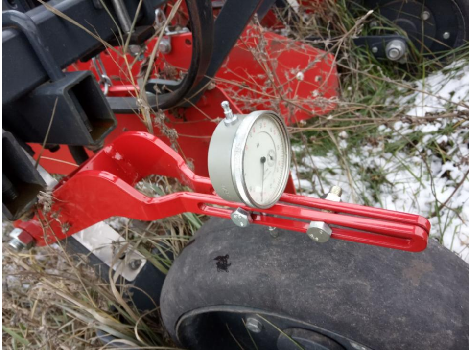
Рис. 3.2. Пристосування для вимірювання радіального зазору котка
