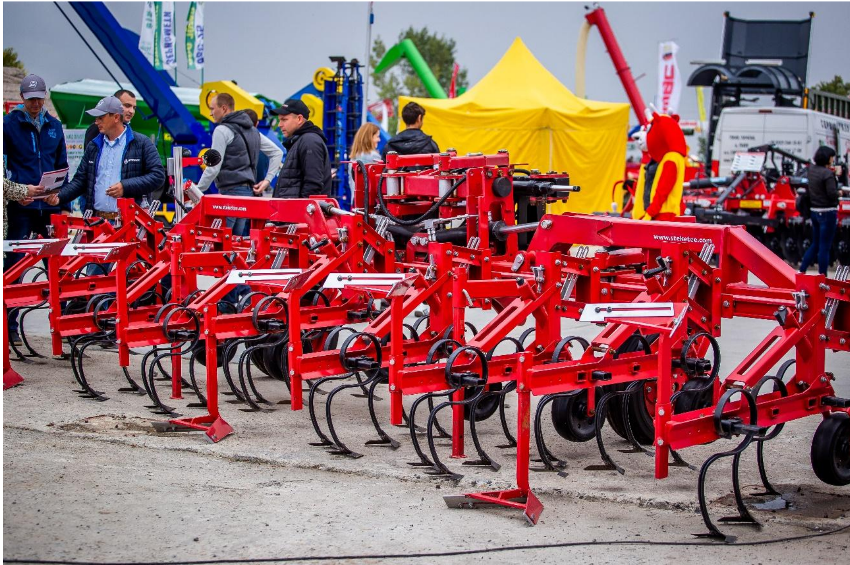
Рис. 5. Секція просапного культиватора легка (55 кг) з лапами-підгортачами
