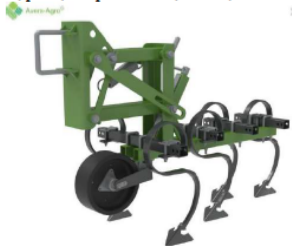
Рис. 1. Конструкція секції просапного культиватора
