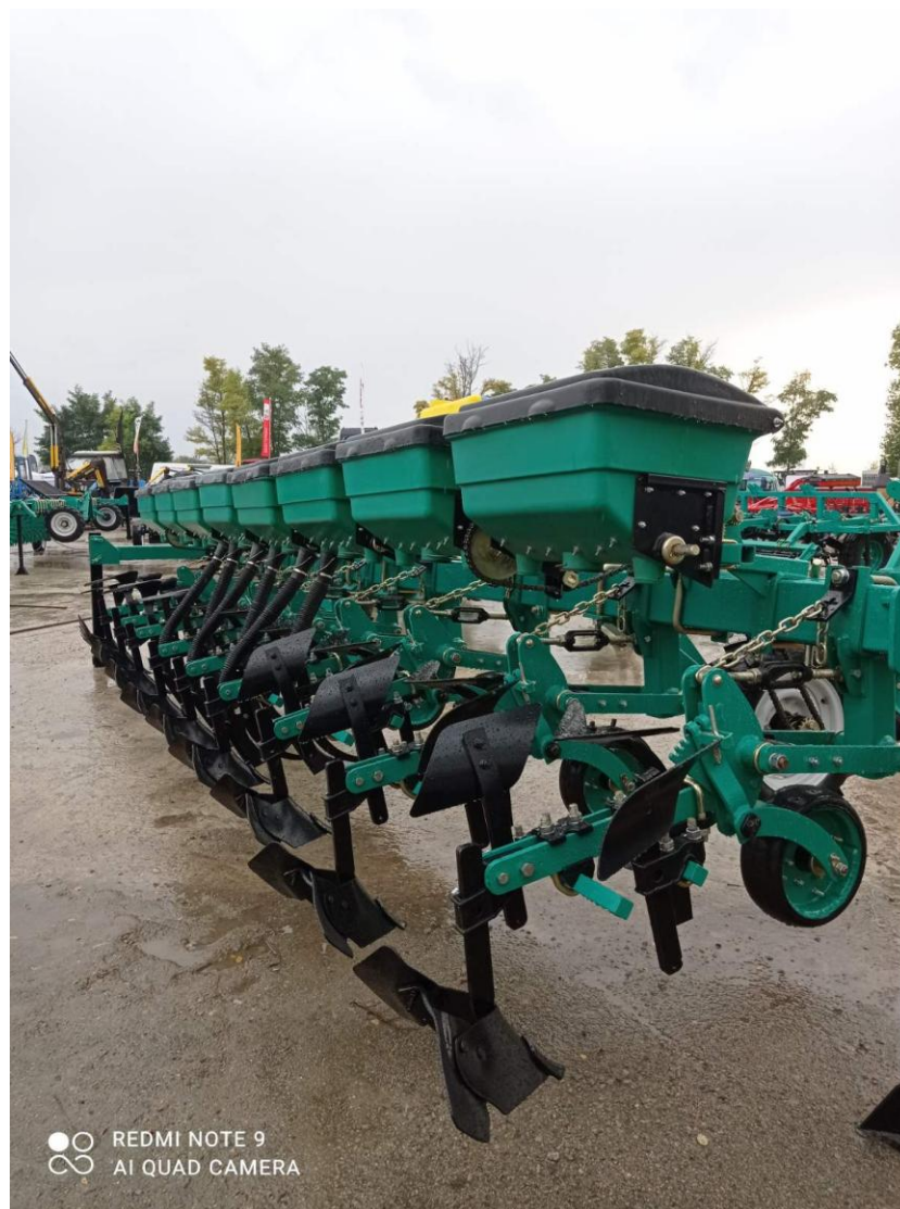
Рис. 7. Секція просапного культиватора легка (55 кг) з лапами-підгортачами
