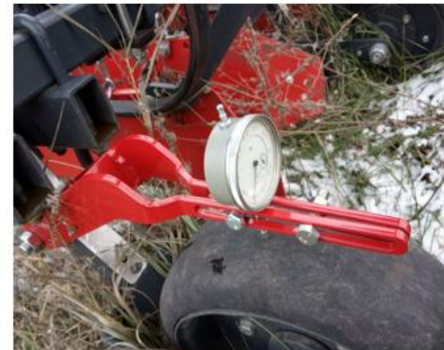
Прийом для вимірювання радіального зазору котка
