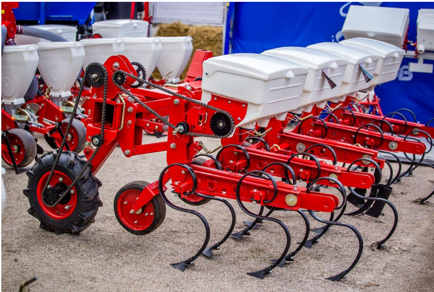
Рис. 3. Секція просапного культиватора середньо-важка (75 кг) з системою внесення добрив
