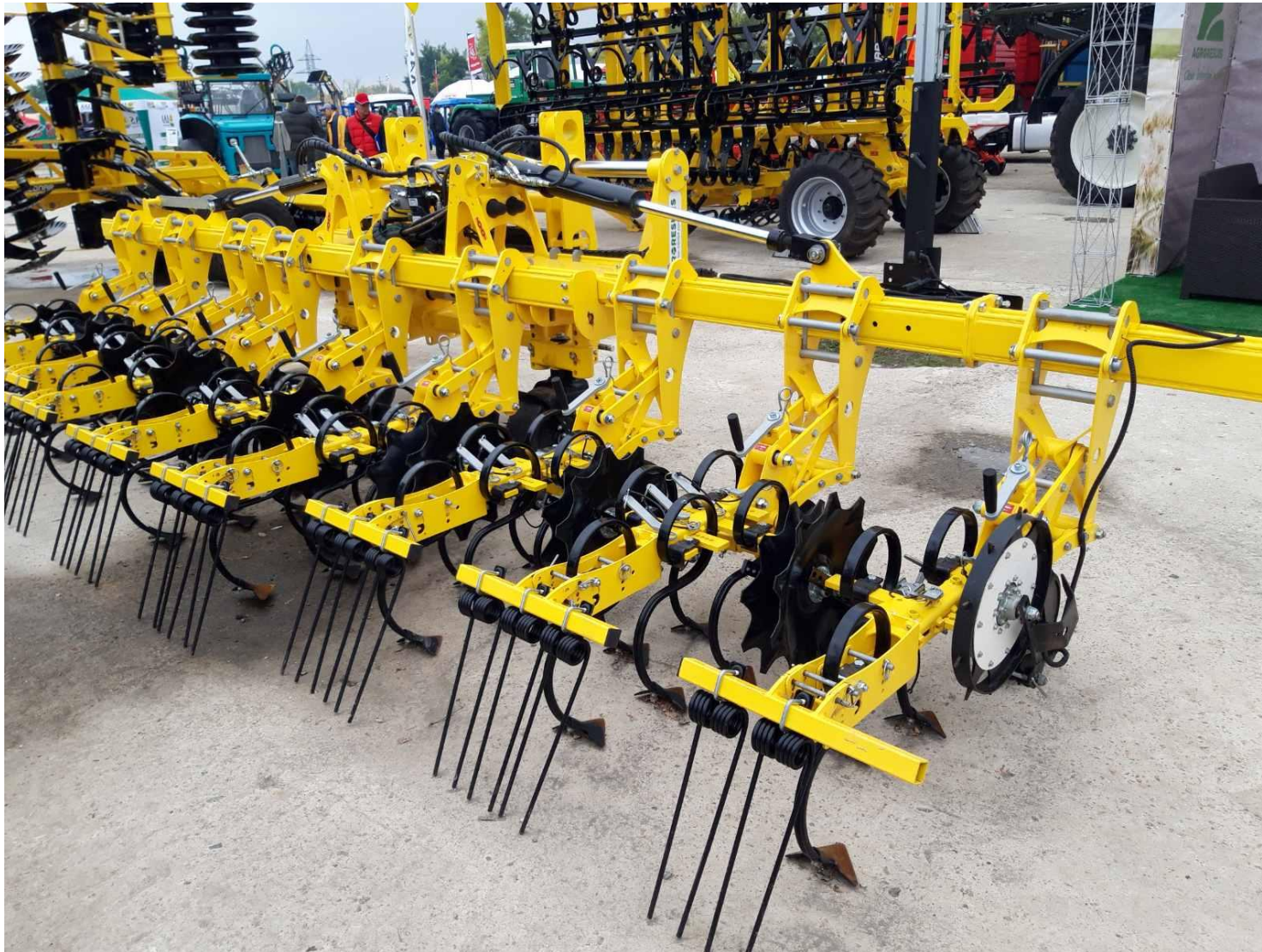
Рис. 6. Секція просапного культиватора легка (55 кг) з захисними дисками, борінками
