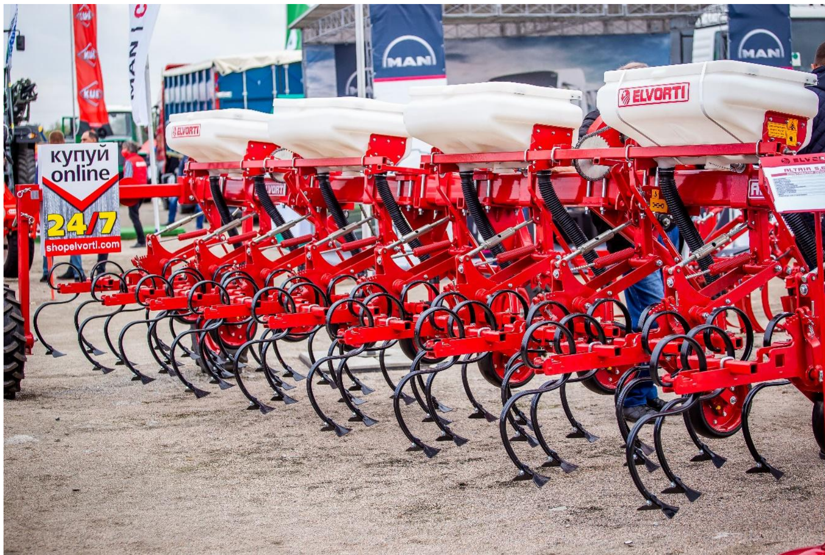
Рис. 4. Секція просапного культиватора легка (60 кг) з системою внесення добрив
