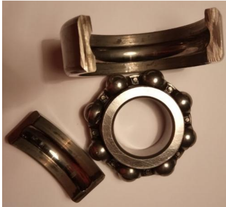
Рис. 3.9. Радіальний шарикопідшипник відкритого типу, зношений, робочі поверхні
