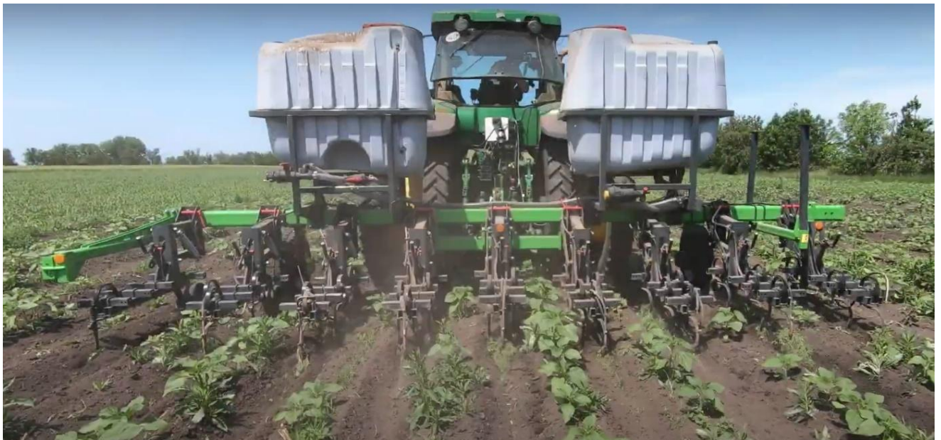
Рис. 3.1. Випробування стійкості ходу лап просапного культиватора [8]
