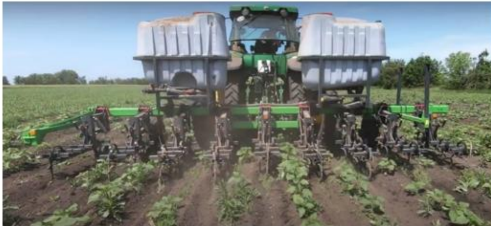
Випробування стійкості ходу лап просапного культиватора
