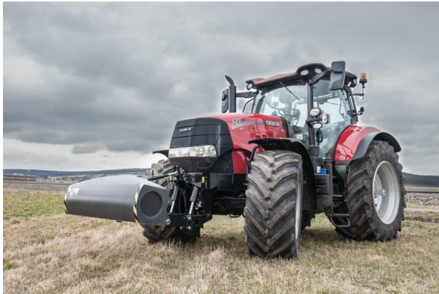
Рис.5.1. Трактор Case IH 240 Magnum, обладнаний системою Topsoil Mapper
