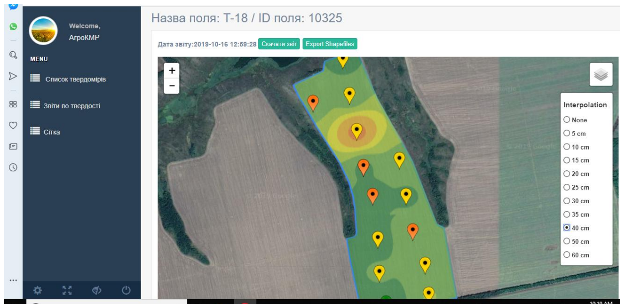
Рис.3.3. Результати замірів твердості ґрунту на глибині 40 см.
