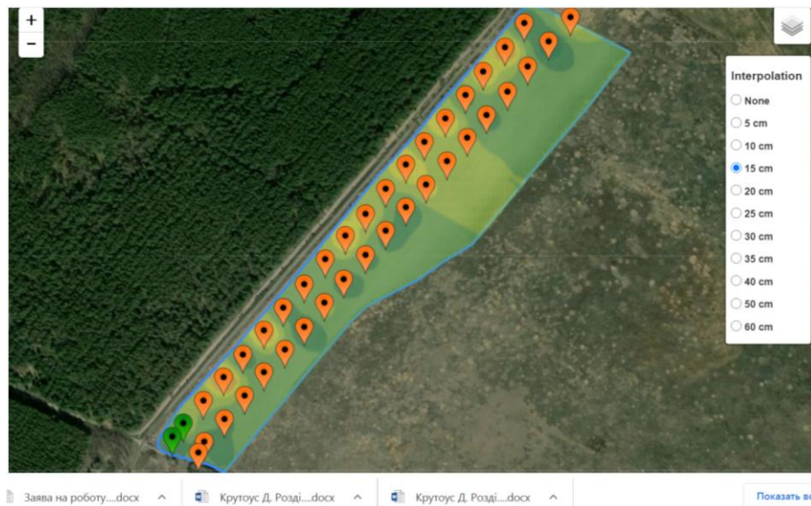
Рис.3.6. Схема вимірювань твердості на умовне значення її на глибині 15 см.
