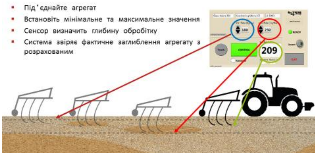
Рис.3.13. Укрупнена принципова схема налаштування агрегату на диференційований обробіток ґрунту.
