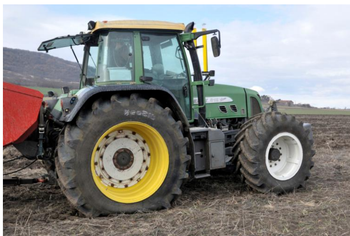
Рис.1.6. Трактор, обладнаний шинами «Ultraflex» при розкиданні мінеральних добрив.
