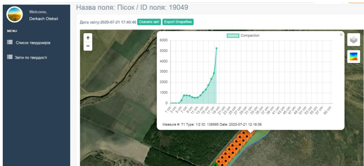
Рис.3.8. Виявлення плужної підшви на глибині до 19 см.
