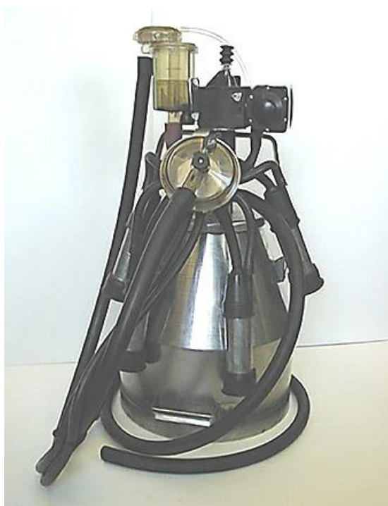
Рисунок 1.6 - Доїльний апарат «Нурлат» з дворівневим вакуумом
