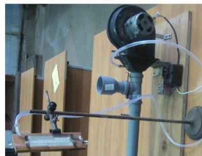
Обладнання для вимірювання статичного тиску в трубопроводі пневмотранспортера
