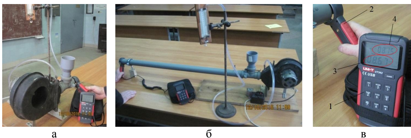
а – на початку транспортного трубопроводу; б – вздовж транспортного трубопроводу; в – екран анемометра UT 362; 1 – анемометр; 2 – виносна крильчатка; 3 – індикатор швидкості; 4 – індикатор температури
