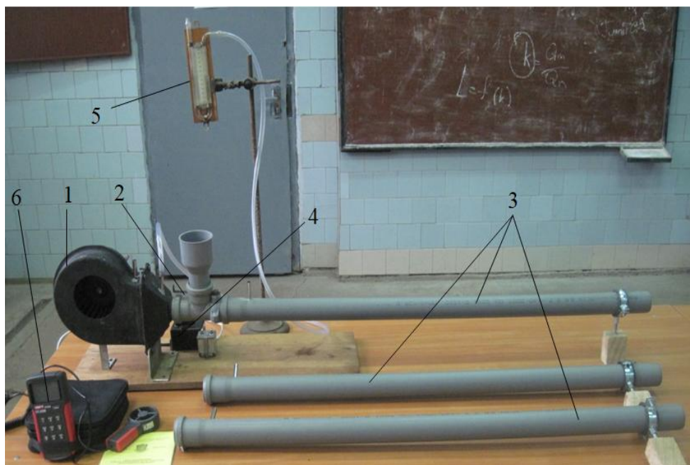
1 – нагнітач повітря (радіальний вентилятор); 2 – вузол подачі насіння; 3 – секції транспортуючого трубопроводу; 4 – вмикач вентилятора; 5 – рідинний U-подібний манометр; 6 – анемометр UT 362
