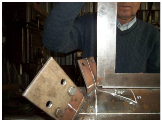
Рисунок 3.3 – Загальний вигляд і геометричні розміри барабанно-лопатевого робочого органу
