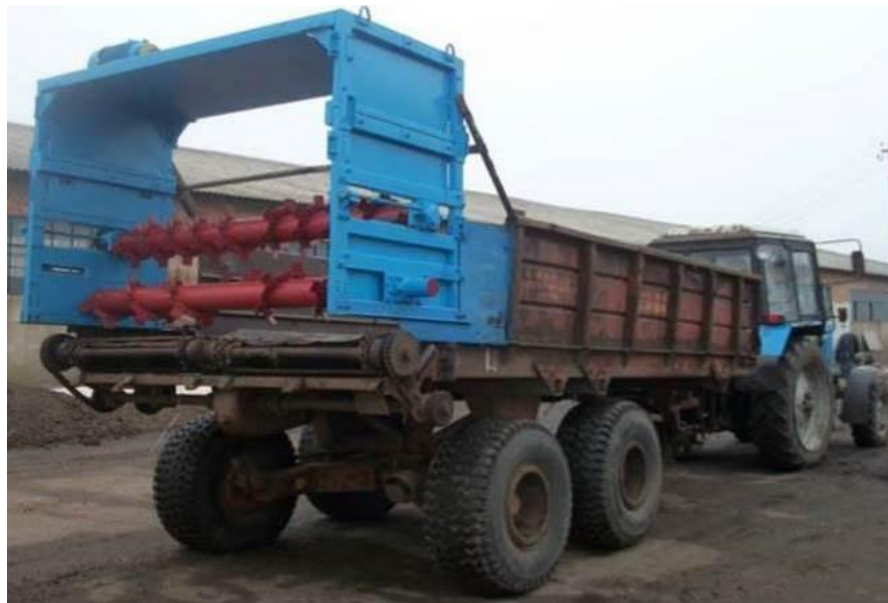
Рисунок 3.1 – Загальний вигляд експериментальної установки для подрібнення і змішування твердих органічних добрив
