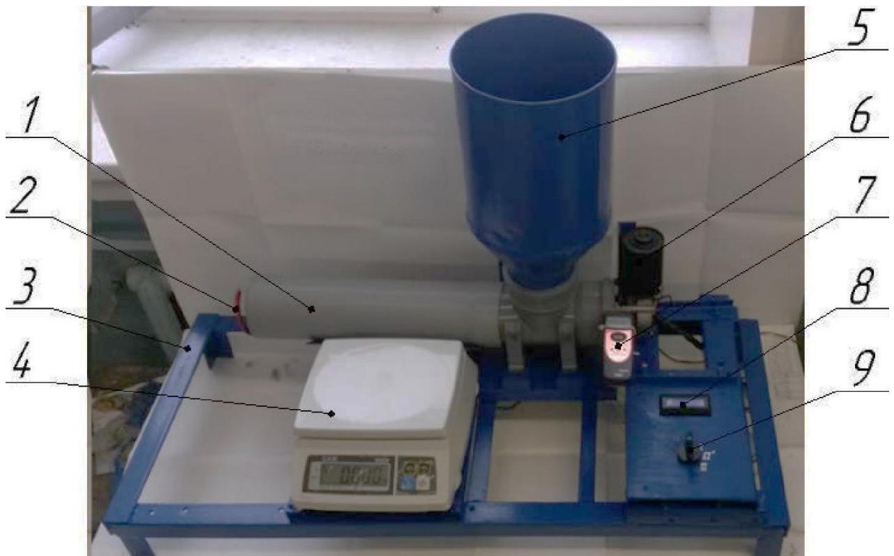
Рисунок 3.1 - Загальний вигляд експериментальної лабораторної установки: 1 - циліндричний корпус; 2 – спіраль; 3 – рама; 4 - ваги CAS SW-05; 5 - бункер з завантажувальною горловиною; 6 – моторредуктор; 7 – тахометр; 8 - амперметр; 9 - перемикач
