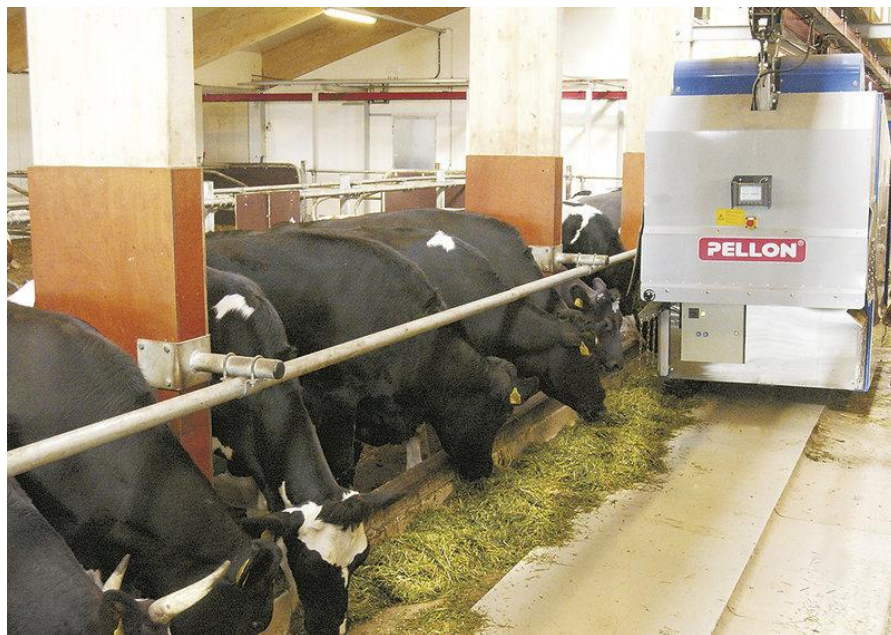
Рисунок 1.4 - Роботизована система годівлі тварин з роздавачем з обмеженою мобільністю
