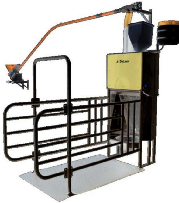
Рисунок 1.16 - Кормостанція фірми Де Лаваль
