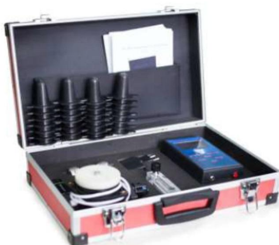
Рисунок 1 – Загальний вигляд тестера доїльних установок
