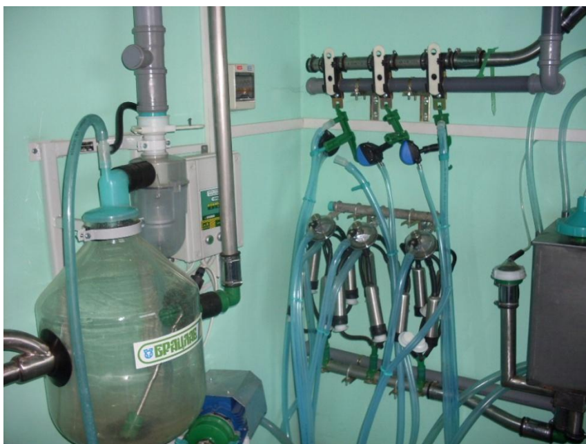
Рисунок 3.4 – Лабораторна модель вакуумної системи доїльної установки
