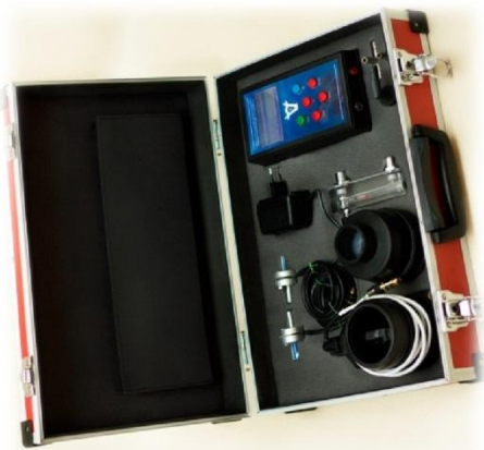
3D модель комплекту устаткування контролю параметрів доїльних установок
