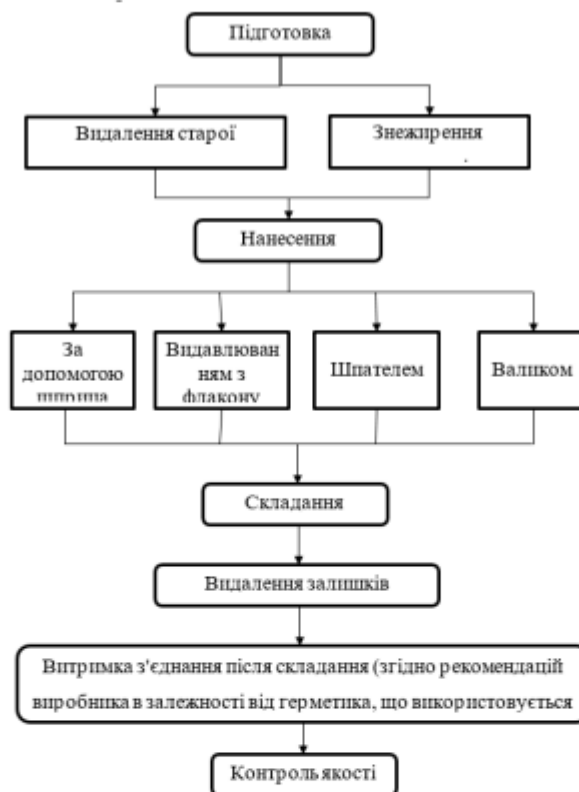
Рис. 2. Технологічний процес Герметизації нерухомих з'єднань агрегатів
