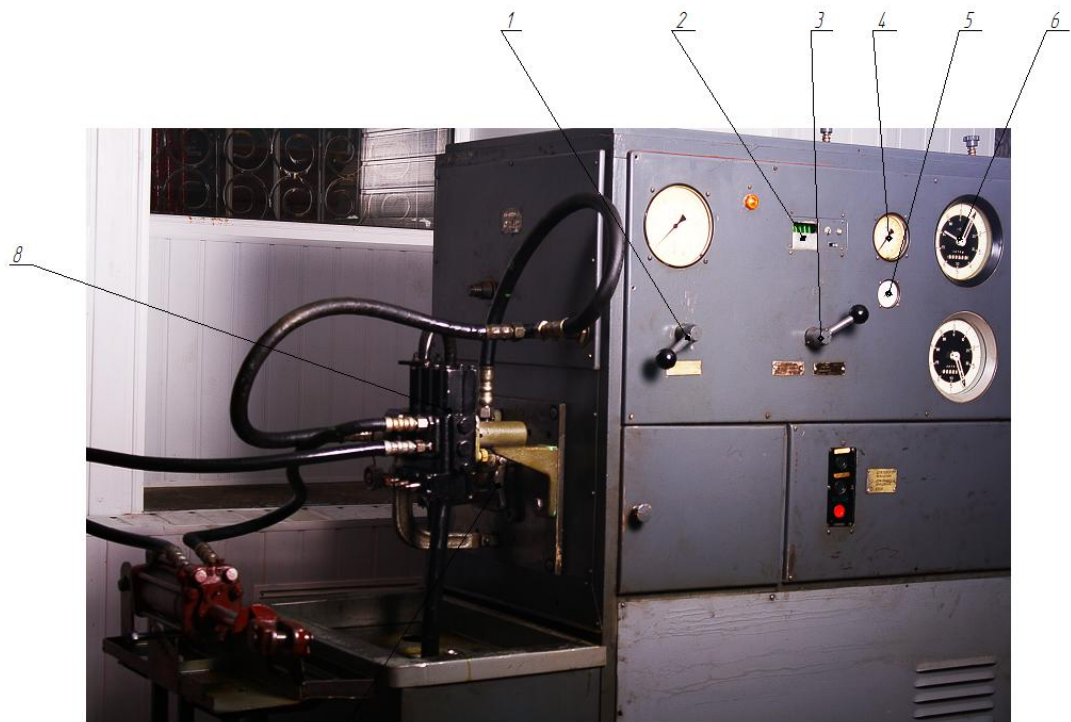
Рисунок 3.1. – Стенд КИ-4815М для проведення експериментальних досліджень: 1-ручка дроселя; 2-лічильник обертів; 3- ручка включення лічильника рідини; 4-манометр магістралі очистки рідини; 5-термометр; 6-лічильники рідини; 7- гідронасос; 8- гідророзподільник.
