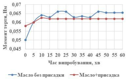
Залежність моменту тертя від часу роботи з'єднання
