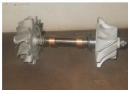
Вузол з плаваючими втулками
