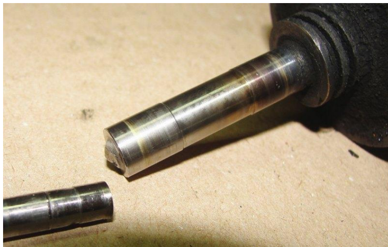
Рис. 3.6. Втомне руйнування валу турбіни
