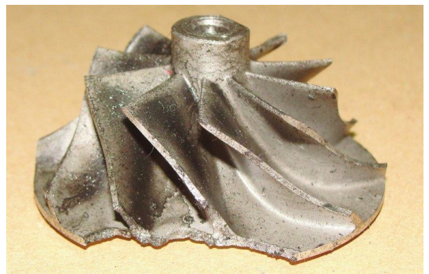
Рис. 3.3. Сліди кольорів мінливості на валу турбокомпресора
