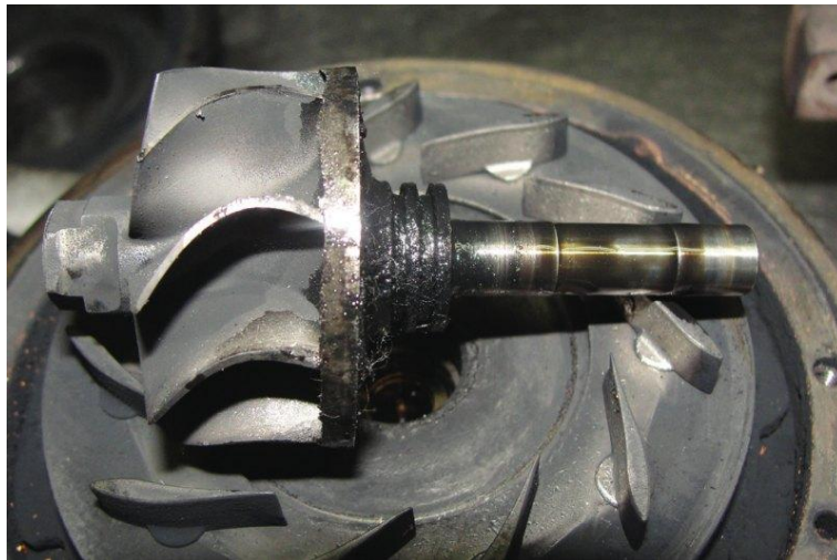
Рис. 3.3. Сліди кольорів мінливості на валу турбокомпресора
