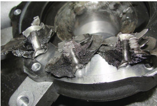
Рис. 3.4. Знос та руйнування крильчатки
