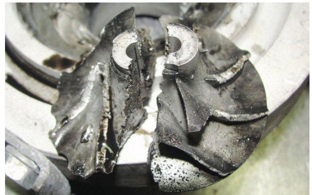
Рис. 3.4. Знос та руйнування крильчатки
