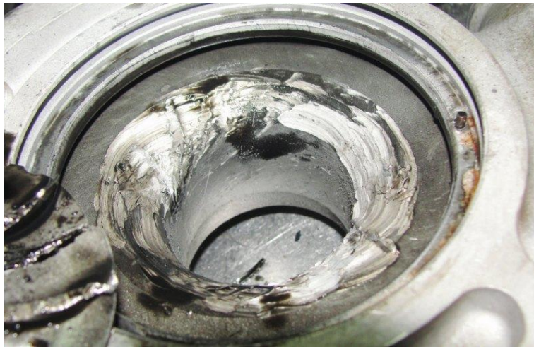
Рис. 3.5. Задири на корпусі равлика від крильчатки
