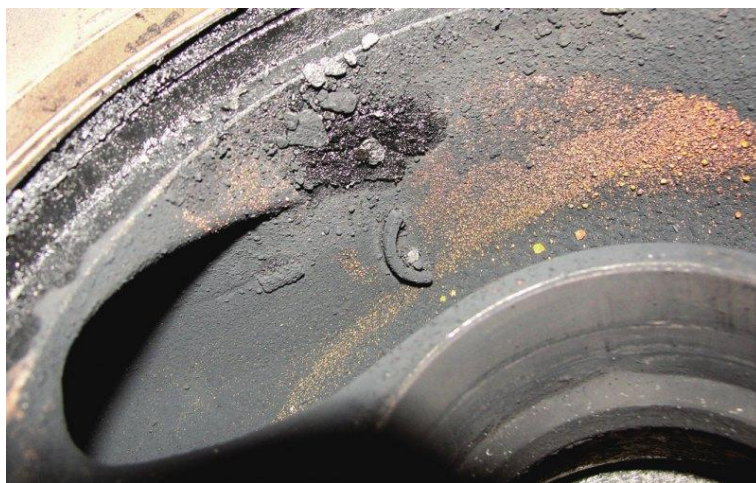
Рис. 3.7. Бруд поза турбінного походження
