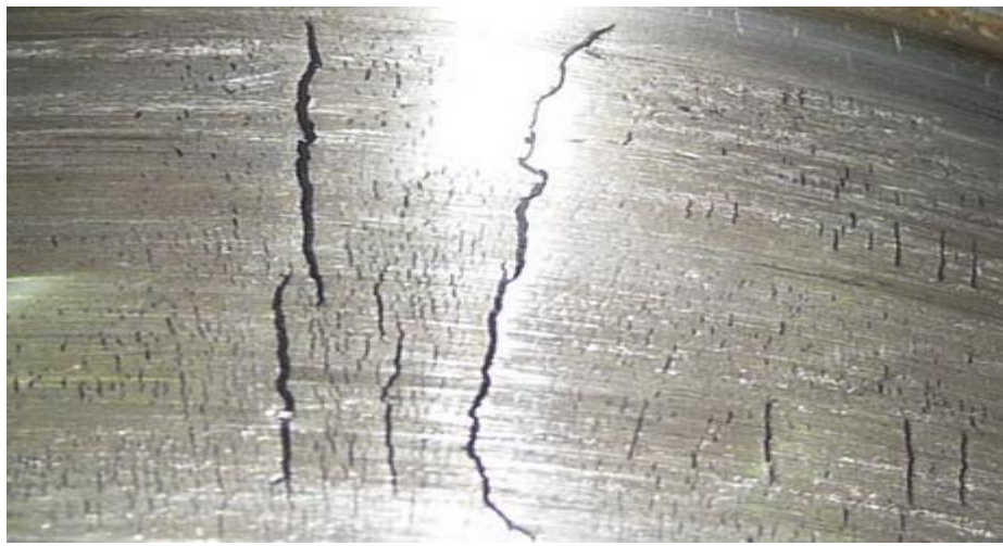
Рис. 1.3. Тріщини на валах
