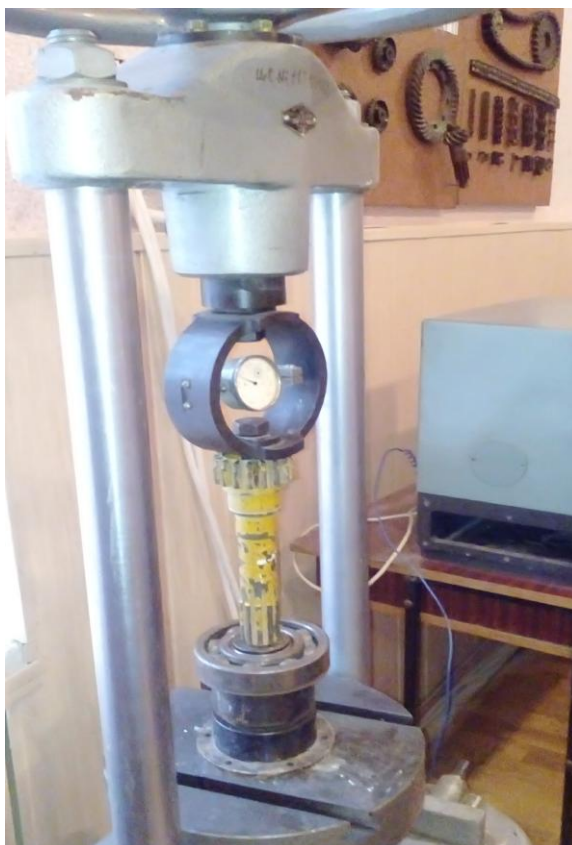
Рис. 3.8. Випробування підшипника на зрив з місця
