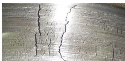
Абразивний знос на опорі вала
