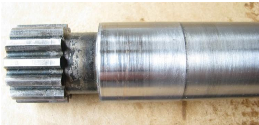
Рис. 1.2. Абразивний знос на опорі вала
