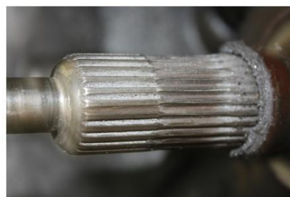
Знос шліців на первинному валу коробки передач
