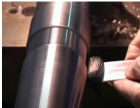
Рис. 3.4. Схема нанесення металополімеру шпателем
