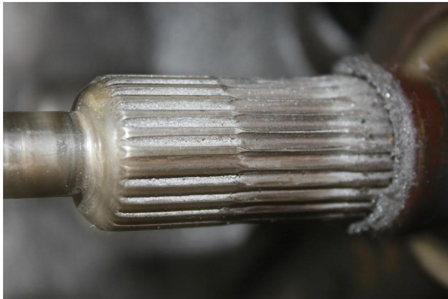
Рис. 1.5. Знос шліців на первинному валу коробки передач
