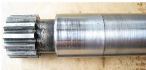
Абразивний знос на опорі вала
