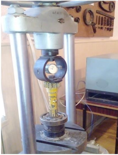
Випробування підшипника на зрив з місця
