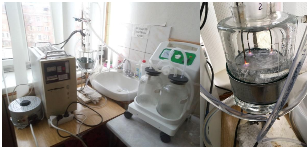
Рисунок 2.3 – Експериментальна установка для плазмохімічної обробки води
