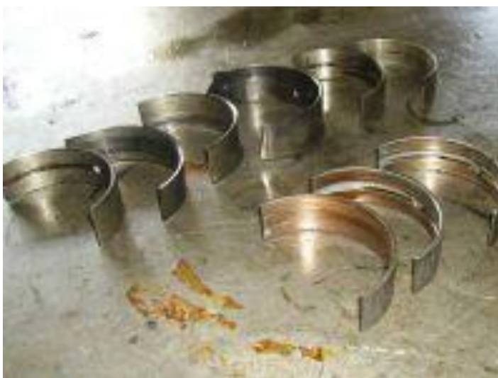
Рис. 2.8. Вкладиші крайніх опор (знос незначний)
