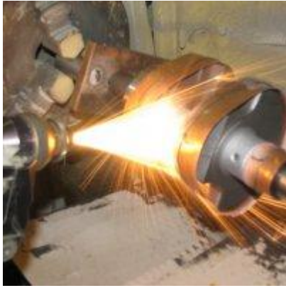
Рис. 3.1. Установка для електроіскрового наплавлення циліндричних поверхонь
