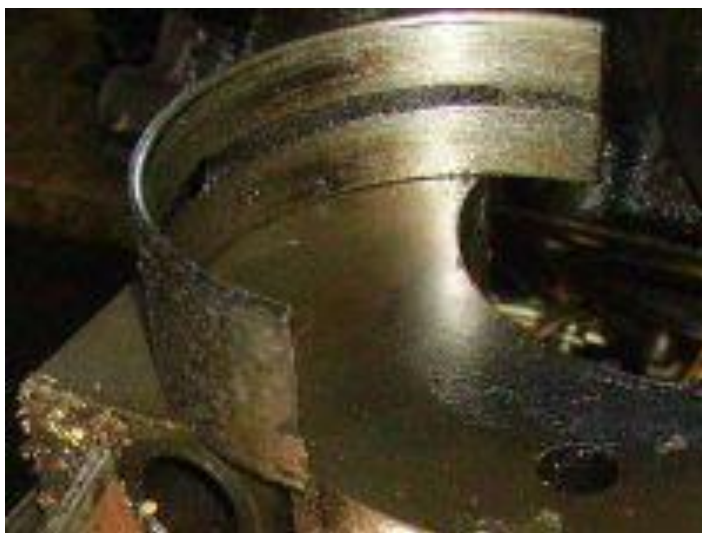
Рис. 2.7. Знос корінних вкладишів (риски, подряпини та обірвані вусики)
