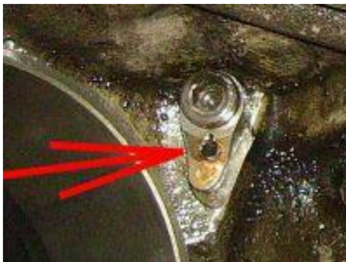
Рис. 2.4. Злам масляної трубки
