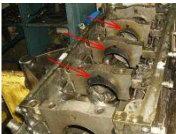
Рис. 2.5. Знос корінних опор (сліди кольорів побіглості)
