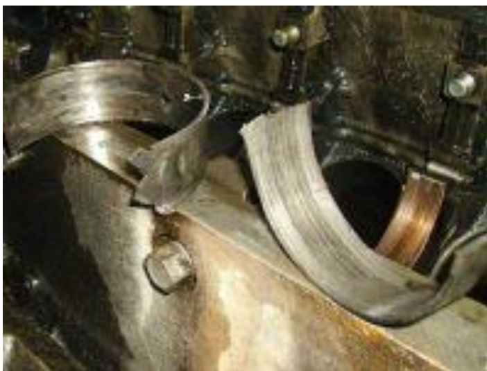
Рис. 2.6. Знос корінних вкладишів (розплескані кінці)
