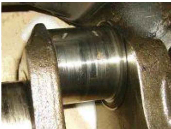
Рис. 2.12. Знос шатунної шийки
