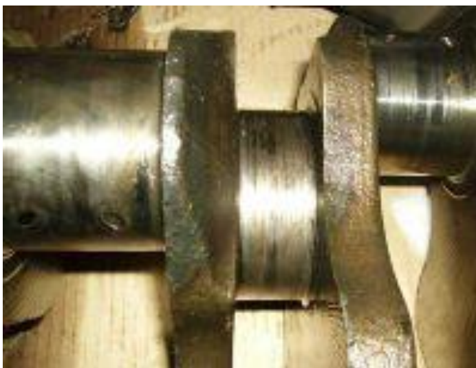
Рис. 2.11. Знос корінної шийки
