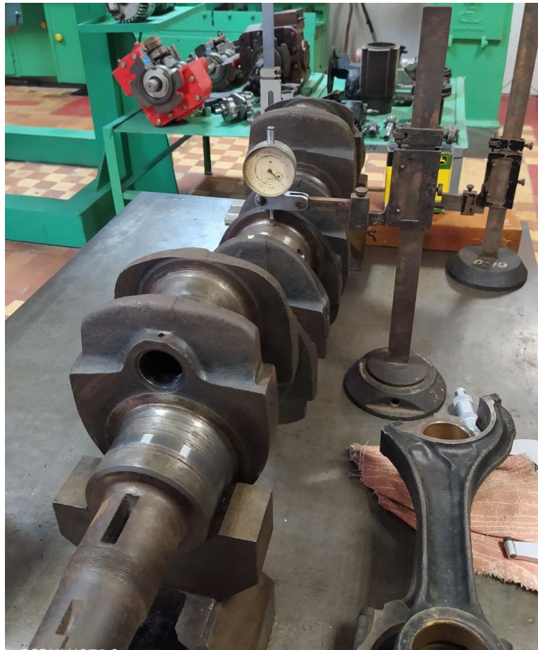
Рис. 3.6. замір прогину вала
