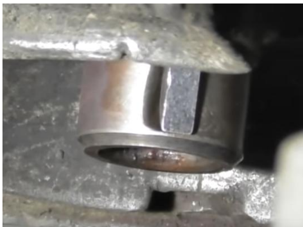
Рис. 2.2. Розбито шпонковий паз
