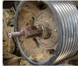
Заржавіле шпонкове з'єднання комбайна
