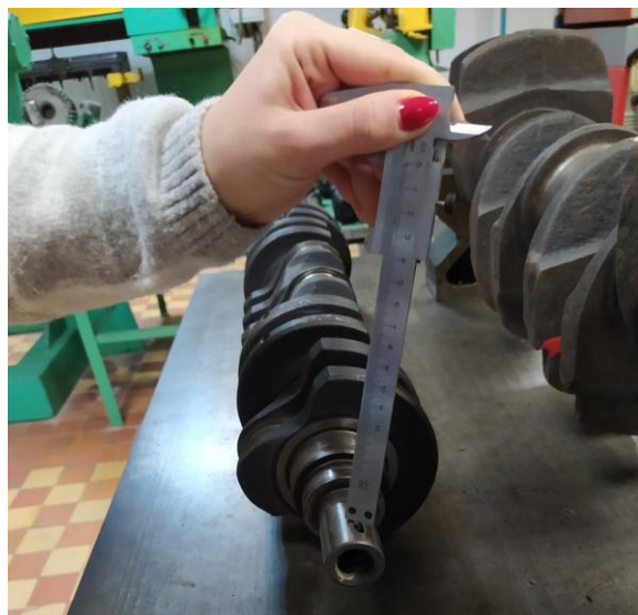
Рис. 3.3. Вимірювання глибини шпонкового пазу
