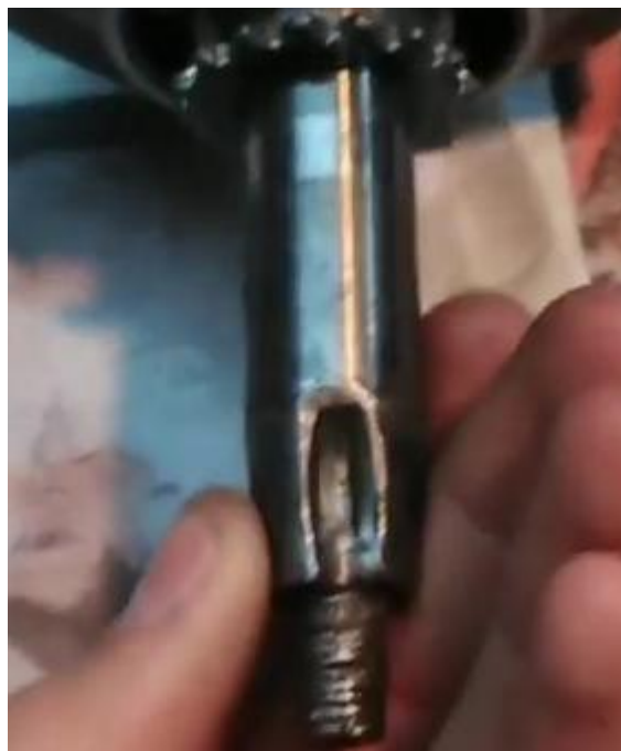
Рис. 2.2. Розбито шпонковий паз
