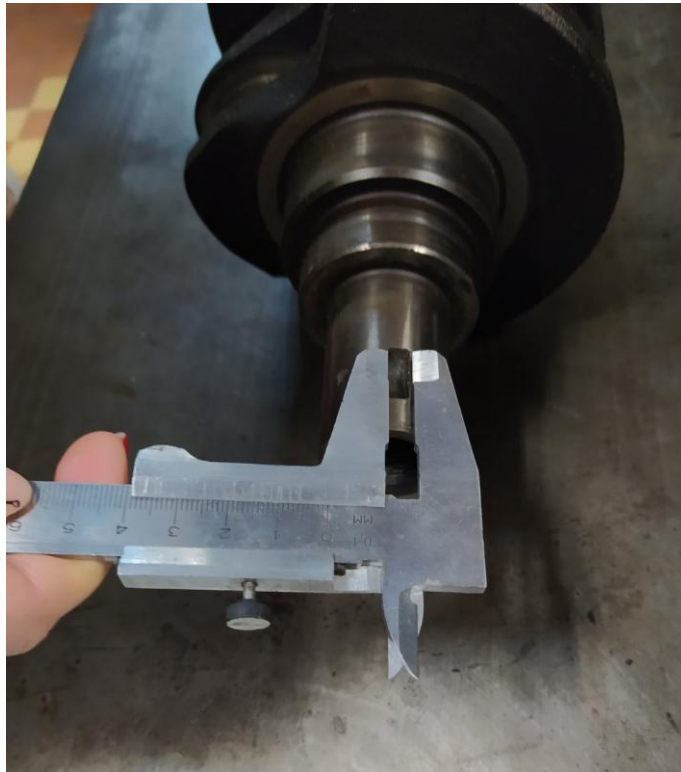
Рис. 3.4. Забір ширини шпонкового паза
