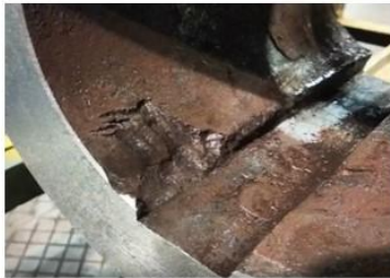
Знос шпонкового пазу на шківу
