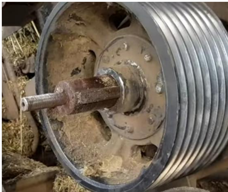
Рис. 2.4. Заржавіле шпонкове з'єднання комбайн ДОН 680
