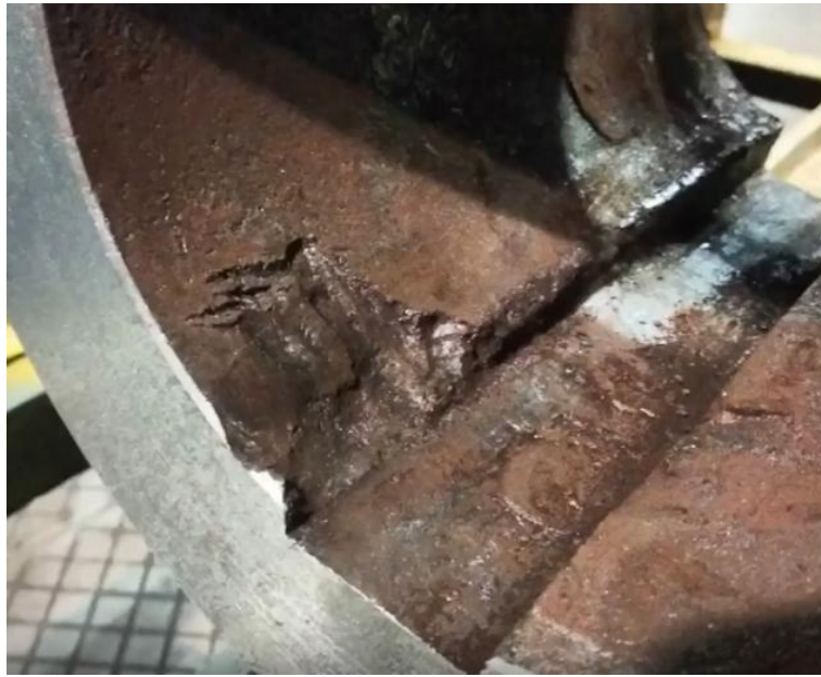
Рис. 2.3. Знос шпонкового пазу на шківу
