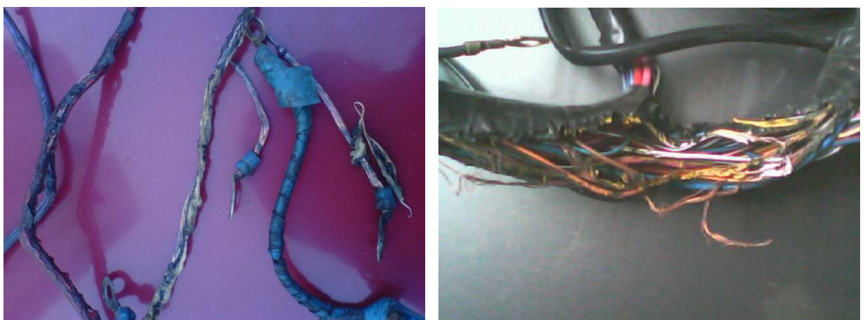
Рис. 1.9. Оплавлення обмотки внаслідок замикання свічки накаливання на масу
