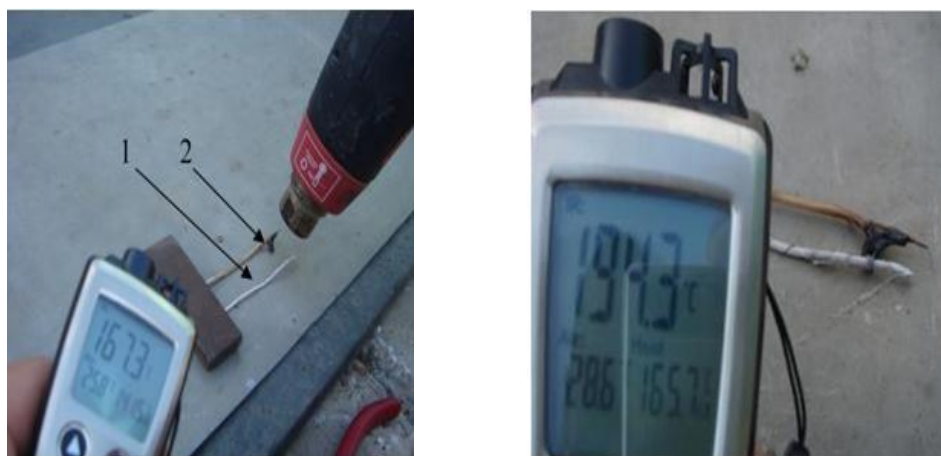
Рис. 4.4 - Процес проведення порівняльної оцінки електропроводів з ізоляцією із фторопласта марки МГТФ (1) і ПВХ (2)
