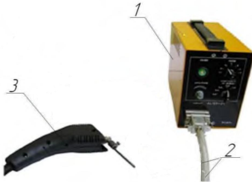
Рисунок 3.6 – Загальний вид модернізованої установки « ALIER-31 »: 1 – генератор; 2-кабель; 3 – електромагнітний вібратор
