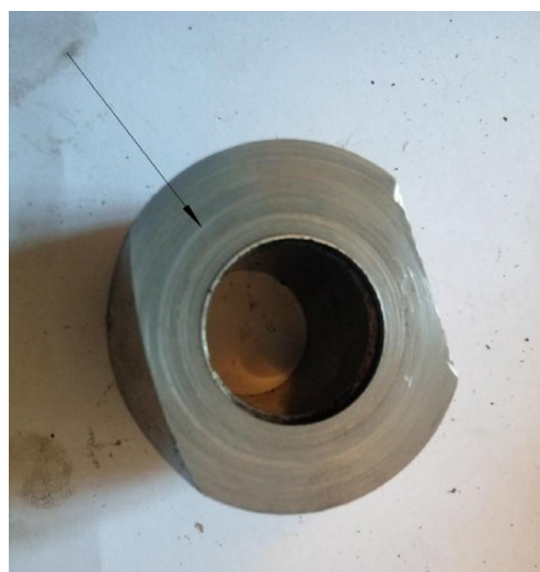
Рисунок 1.4 - Гідроабразивне спрацювання торця втулки насоса НШ-У
