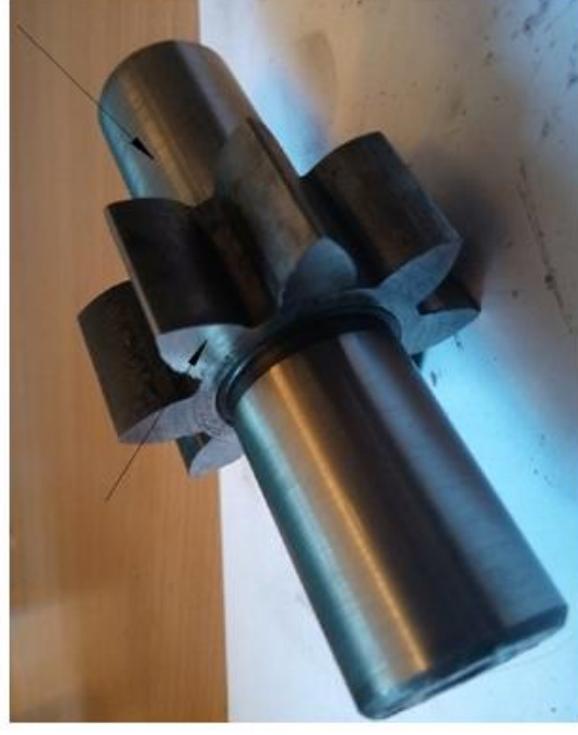
Гідроабразивне зношення цапф введеної шестерні і її торця зубів насоса НШ-У 3
