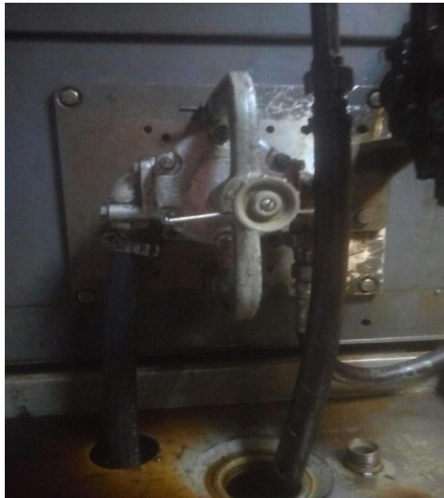
Рис. 3.4 – Експериментальний насос НШ-50-К встановлений на стенді КИ-4815М для проведення експериментальних досліджень.
