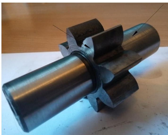
Рисунок 1.5 – Гідроабразивне зношення цапф веденої шестерні і її торця зубів насоса НШ-У
