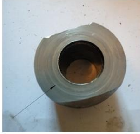
Гідроабразивне спрацювання торця втулки насоса НШ-У
