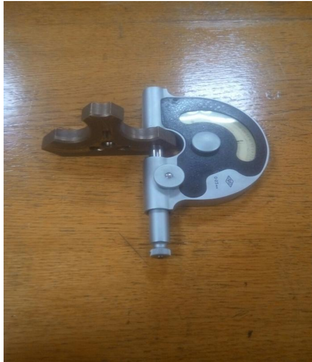
Рисунок 3.2 - Методика замірювання товщини пластика-замикача
