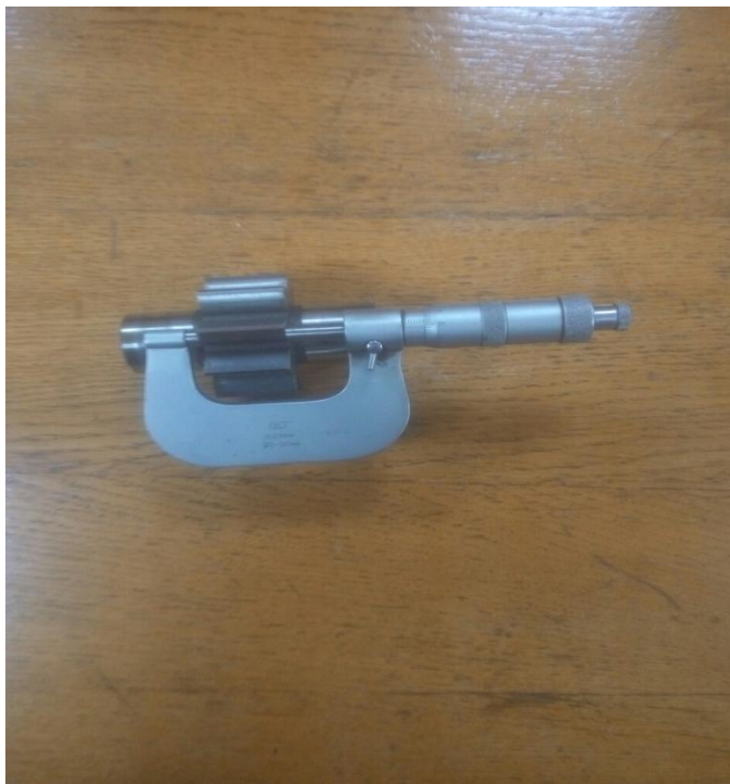
Рисунок 3.1 – Методика замірювання довжини зубів шестерень
