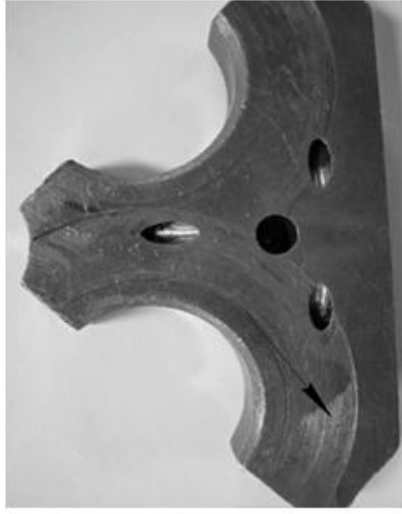
Гідроабразивне зношення торцевої поверхні платика
