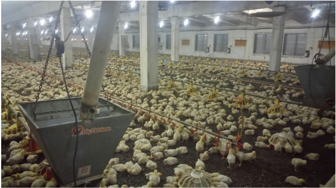
Рис. 1. Внутрішній вигляд корпусу пташника на відділенні «Нетельне» облаштованого кормороздатковою системою Augermatic з хоперами Big Dutchman
