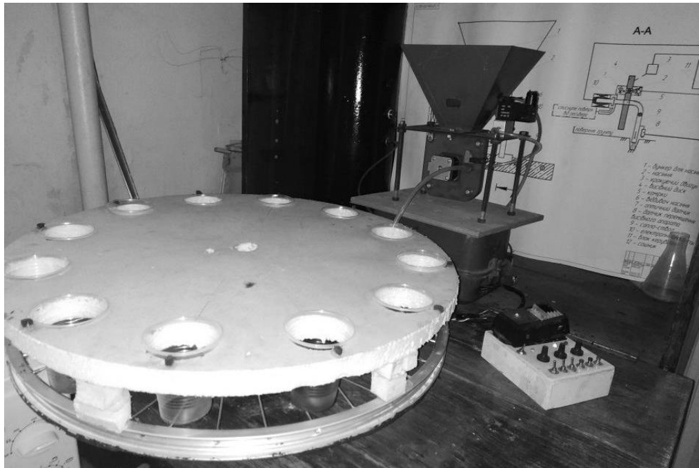
Рисунок 4.6 – Загальний вигляд лабораторної установки для визначення впливу конструктивно-технологічних параметрів модернізованої овочевої сівалки на якість висіву
