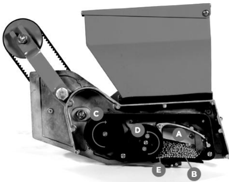
Рисунок 1.3 – Стрічковий висівний апарат „Стенхей”.
