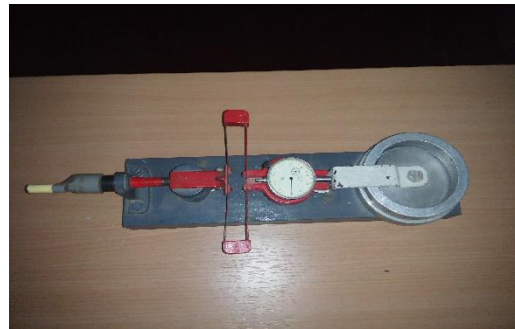
Рисунок 3.3 – Конструктивна схема і загальний вид зсувного приладу : 1 – обойма нерухома; 2 – обойма рухома; 3 – кришка; 4 – відтарований пружний елемент; 5 – упор; 6 – мікрометр.
