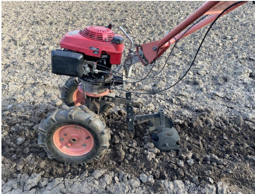
Рисунок 4.2 – Типовий загальний вид борозни після одиночного проходу агрегату
