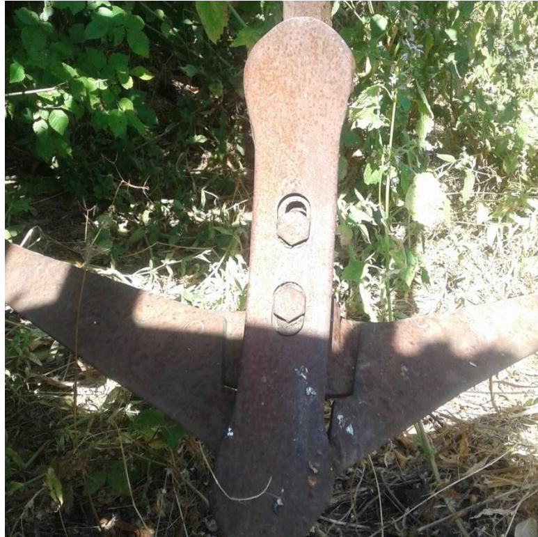
Рисунок 2.6 – Прийнята до експериментальних досліджень стрільчаста лапа (варіант №2)
