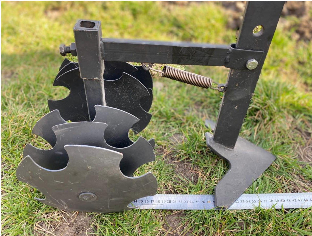
Рисунок 4.1 – Загальний вид агрегату у комплектації з модифікованою серійною стрільчастою лапою
