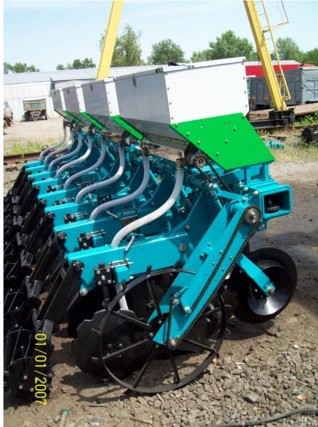
Рисунок 1.9 – Комбінований агрегат смугового землеробства АСОГ-8 обладнаний механізмом внесення добрив.
