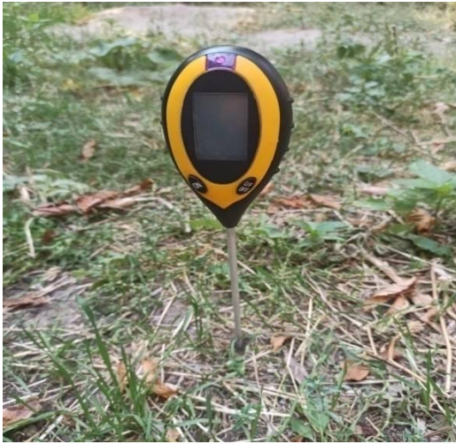
Рисунок 3.1 – Визначення пенетрометром стиглості ґрунту за вологістю
