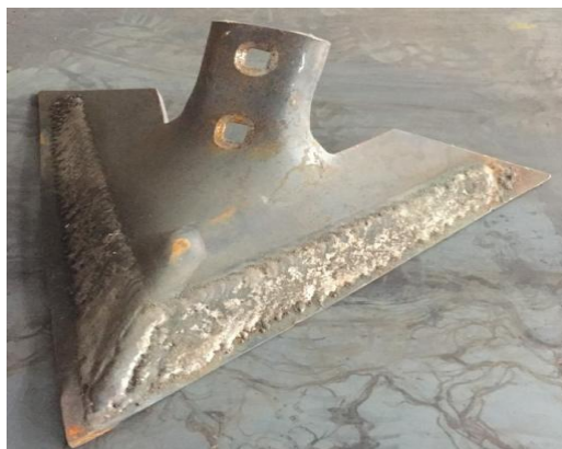
Рисунок 2.5 – Аналітично обґрунтована і прийнята до експериментальних досліджень стрільчаста лапа (варіант№1)
