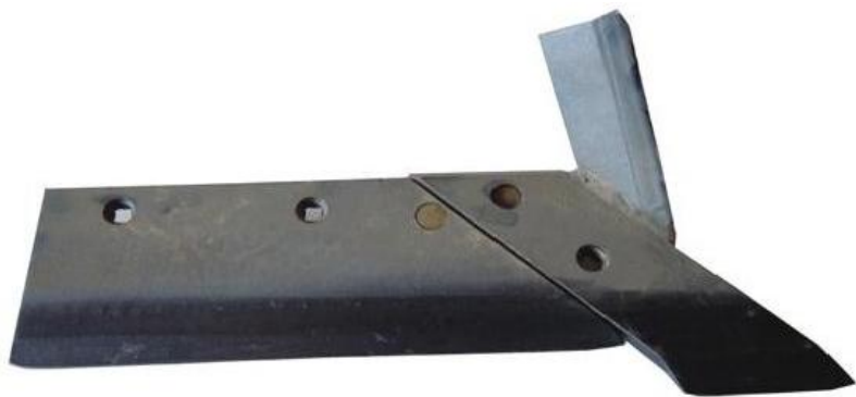
Рисунок 1.5 - Трапецевидний лемеш з накладним долотом.
