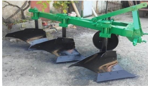
Рисунок 1.17 – Загальний вид плуга з комбінованою полицею БПЛ-3-35
