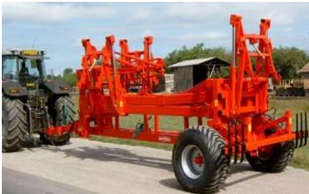
Рисунок 3.9 - Зчіпка сільськогосподарських знарядь ВРО
