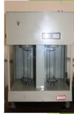
Аналітичні терези ВЛР-200, на яких реалізовано гідростатичне зважування
