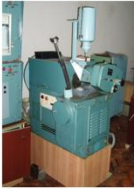
Загальний вигляд машини тертя СМЦ-2 для абразивного зношування матеріалів
