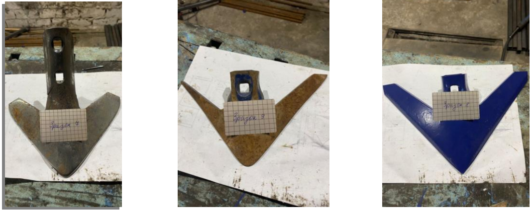
Рис.2.1. Загальний вигляд стрілочних лап, з яких були виготовлені зразки для випробування.
