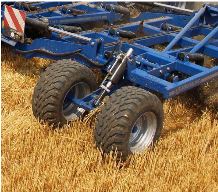
Рис. 1.13 Гідравлічне регулювання глибини «EasyShift»
