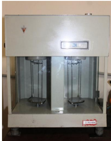
Рис.2.6. Аналітичні терези ВЛР-200, на яких реалізовано гідростатичне зважування.
