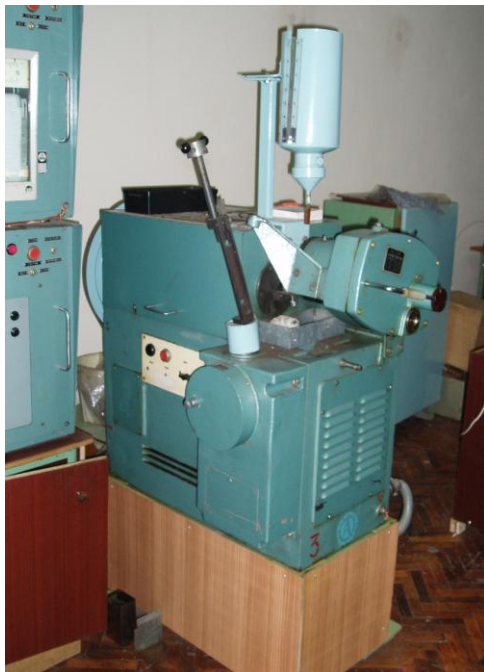
Рис. 2.3. Загальний вигляд машини тертя для абразивного зношування матеріалів
