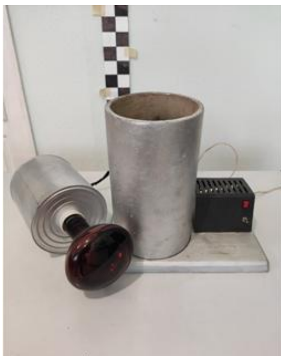
Рисунок 2.2 – Загальний вигляд дослідної установки ІЧ-опомінення харчових продуктів
