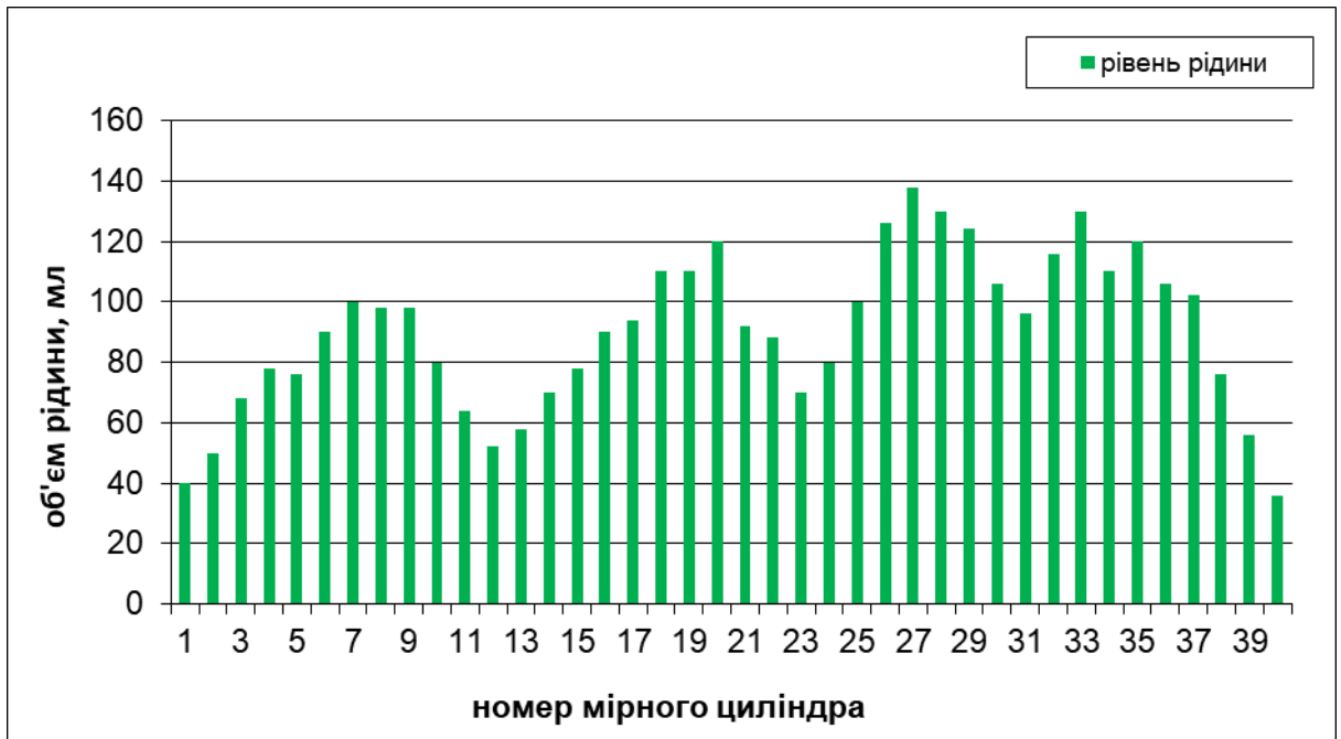
Рис. 4.10. Розподіл рідини по довжині штанги, при P=0,3 МПа; H=0,4 м Рівномірність розподілу розпиленої рідини по довжині штанги оцінюють коефіцієнтом варіації
