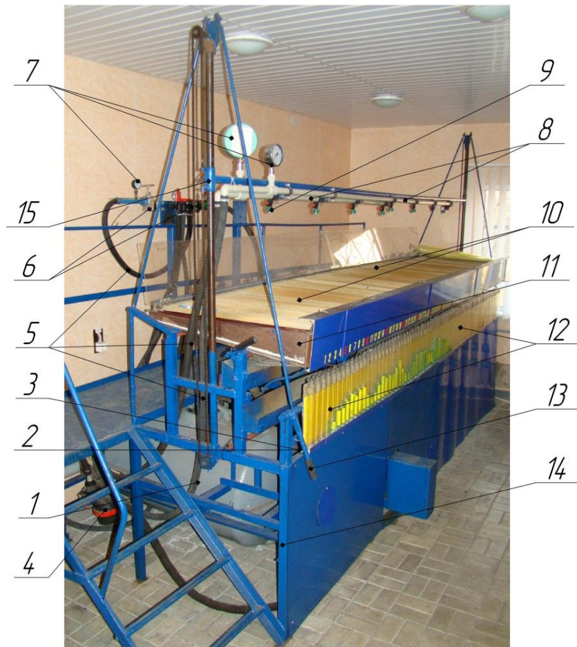
Рис. 3.5. Загальний вид гідравлічного стенду для вимірювання параметрів розпилювачів: 1 – бак; 2 – насос; 3 – електродвигун; 4 – фільтр; 5 – рукав; 6 – регулятор тиску; 7 – манометр; 8 – штанга; 9 – розпилююча головка з розпилювачем; 10 – розподілювачі ; 11 – жолоб; 12 – мірні колби; 13 – поворотний механізм; 14 – рама; 15 – тримач.
