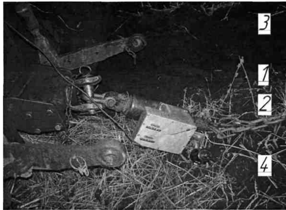
Рисунок 3.18. Кріплення роботоміра РТЖ - А ФМ до веденого трактора: 1 - трактор; 2 - роботомір РТЖ - АФІ; 3 - виоране поле; 4 - незоране поле.
