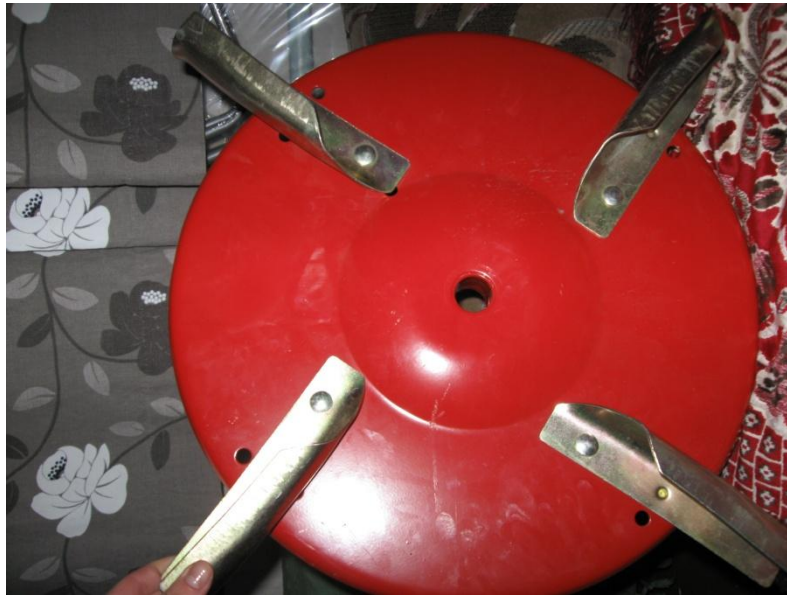
Рис.5.2. Горизонтальний роторний робочий орган еталонний
