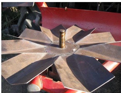
Рис.1. Відцентровий робочий орган з восьмипелюстковими лопатями
