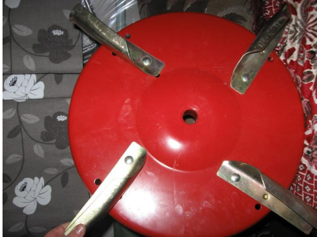
Рис.2. Горизонтальний роторний робочий орган еталонний
