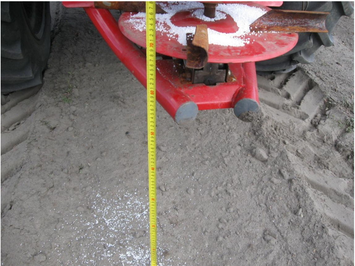
Рис.5.1. Відцентровий робочий орган з восьмипелюстковими лопатями
