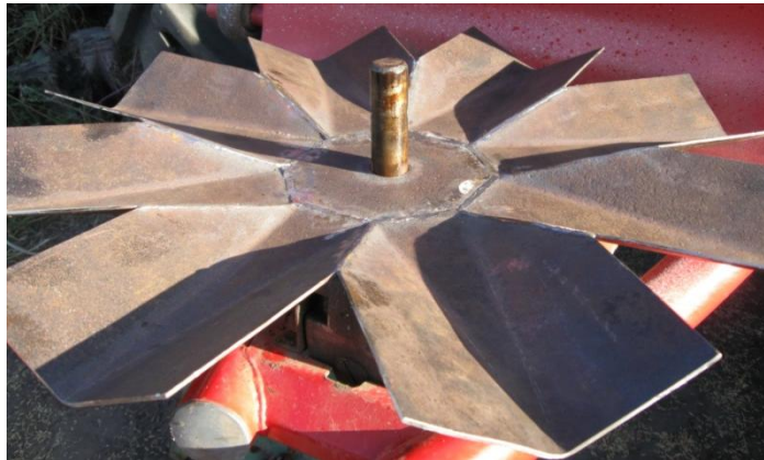
Рис.3.2 Відцентровий робочий орган з восьмипелюстковими лопатями
