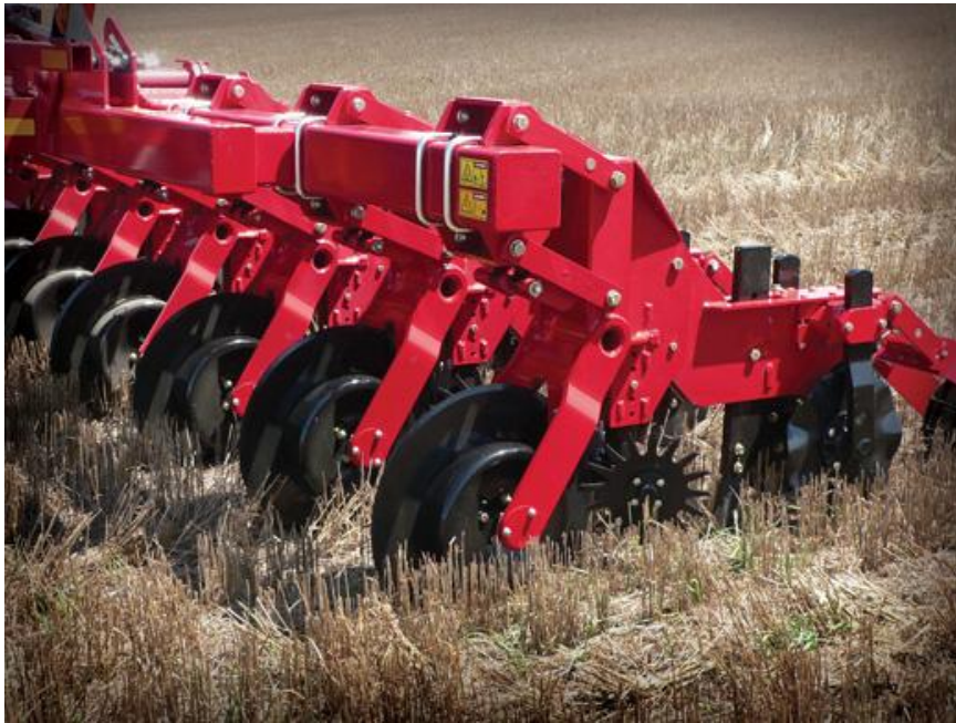
Рисунок 1.5 – Секція ротаційної борони в складі комбінованого ґрунтообробного агрегату : 1 – рама; 2 – колтер; 3 – секція ротаційної борони; 4 – секція турбодиска; 5 – долотоподібний глибокорозпушувач.
