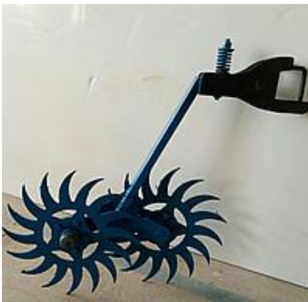
Рисунок 1.2 – Варіант цілнелітото виконання колеса ротаційної борони (важка борона)
