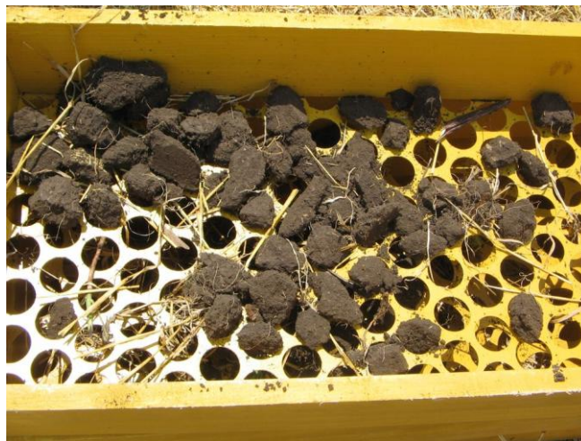
Рисунок 3.11– Просіювання взятої проби ґрунту на решеті
