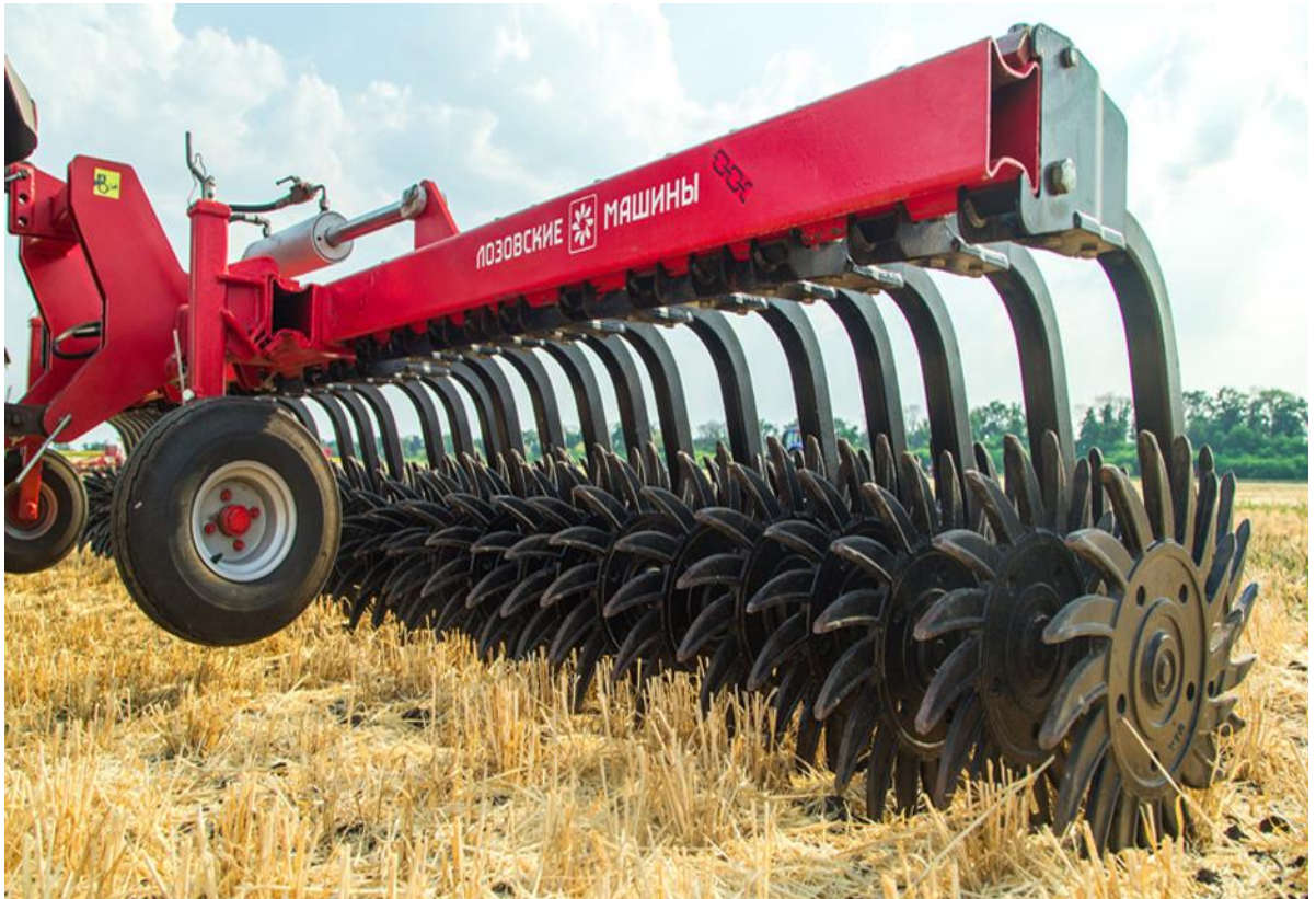
Рисунок 1.2 – Варіант цілнелітото виконання колеса ротаційної борони (важка борона)
