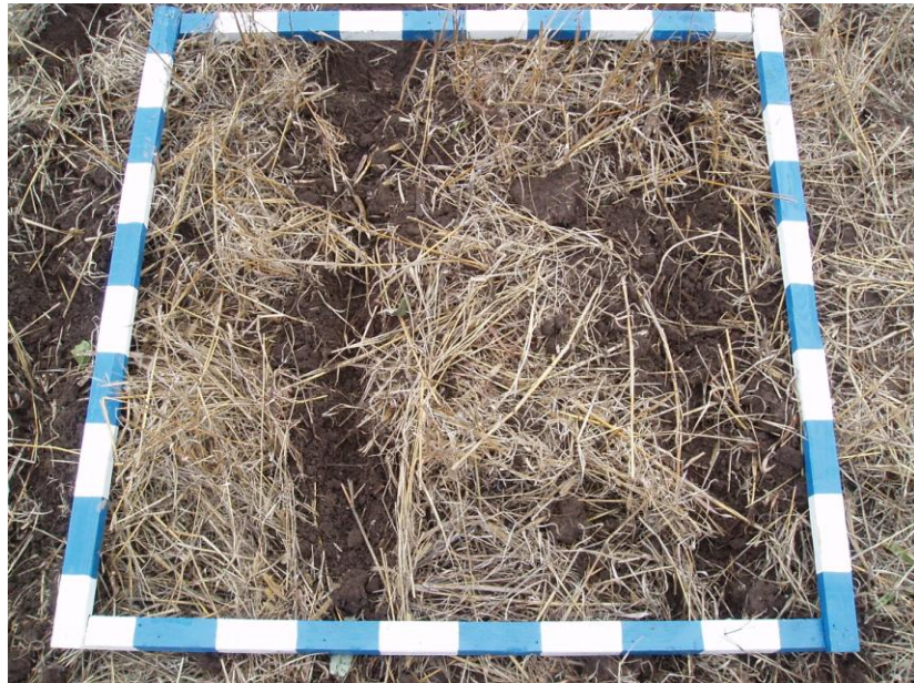
Рисунок 3.4 - Визначення ступеню збереження стерні на поверхні поля
