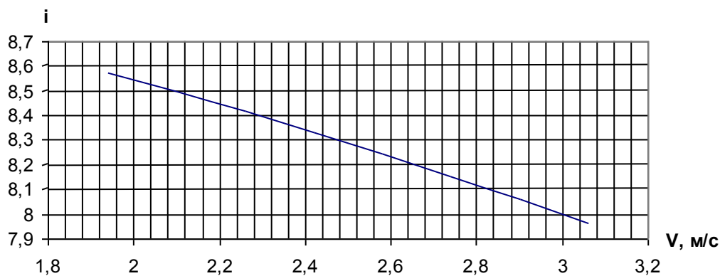
Рисунок 2.3 - Залежність ступеня розпушення ґрунту від швидкості руху МТА при \alpha=45^\circ
