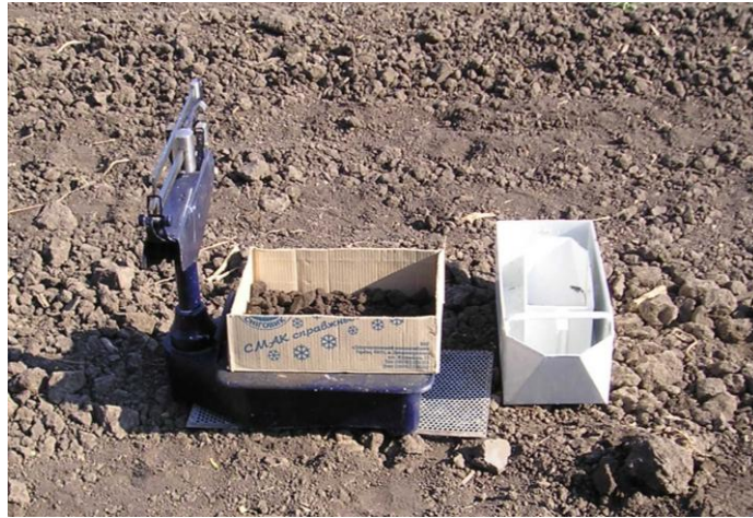
Рисунок 3.2 - Визначення якості розпушення ґрунту
