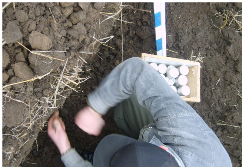
Рисунок 3.2 - Забір проб для визначення вологості ґрунту безпосередньо при профілюванні робочих органів ґрунтообробного знаряддя
