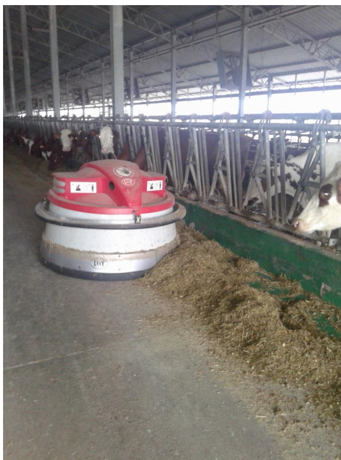
Рис. 25. Автоматична установка-підштовхувач кормів фірми LELY
