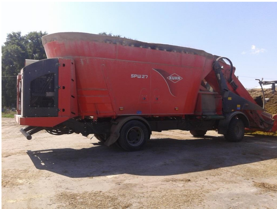
Рис. 23. Кормороздавач фірми KUHN ємністю на 27 м 3
