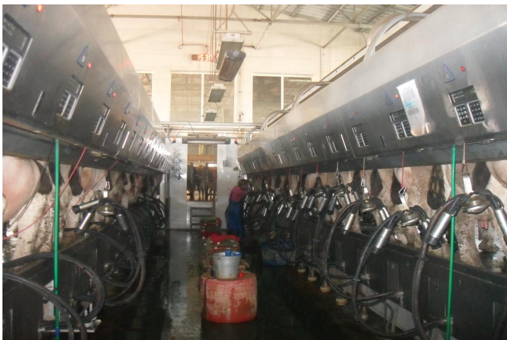
Рис. 28. Доїльний зал типу «Паралель» на 40 доїльних місць
