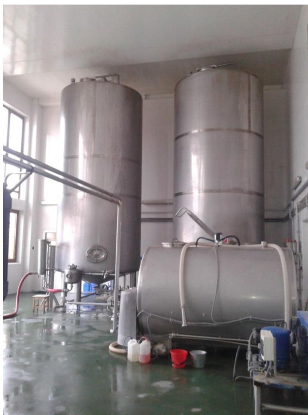
Рис. 30. Резервуар для тимчасового зберігання молока, ємністю 20 т
