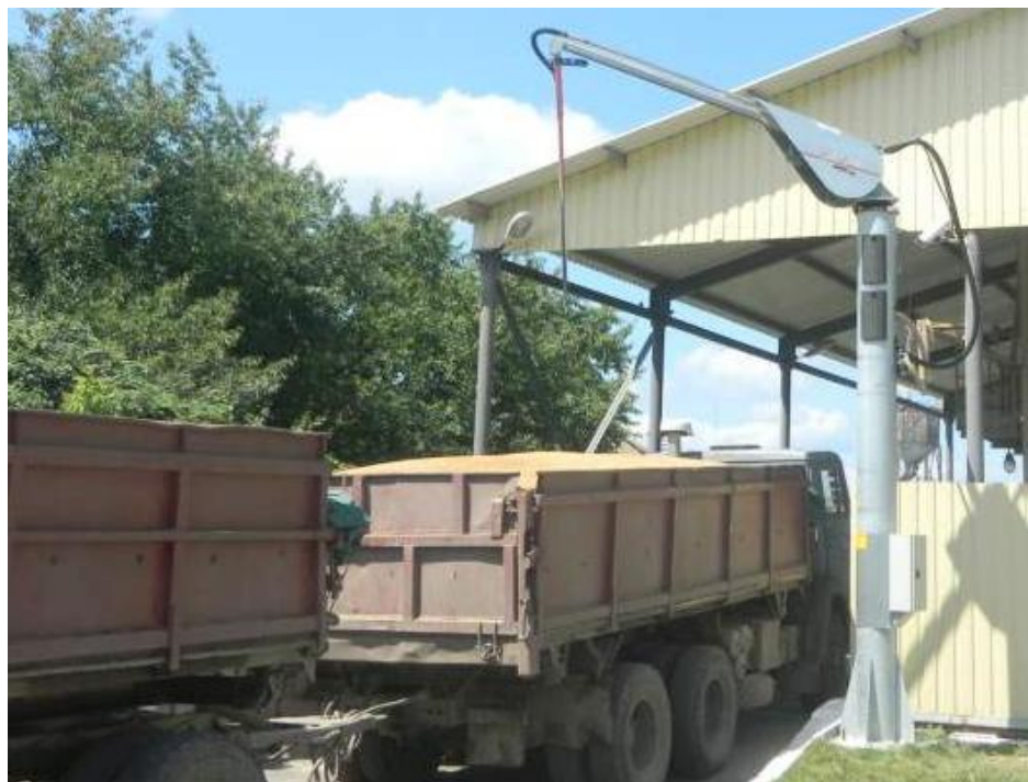
Рисунок 2.2 – Відбір проб автоматичним пробовідбірником Heron-3000
