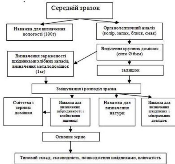
Рисунок 2.3 – Схема відбору наважок зерна для аналізів
