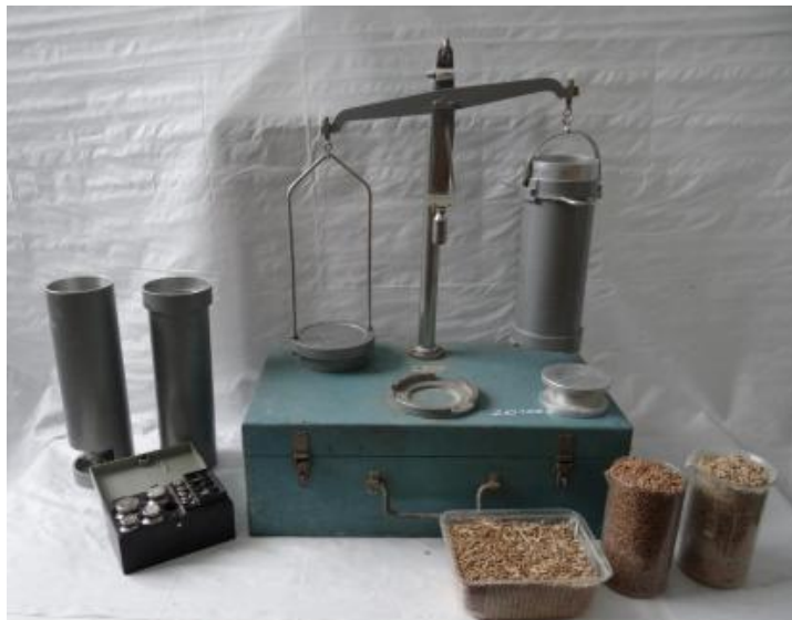
Рисунок 2.1 – Загальний вид літрової пурки ПХ-1
