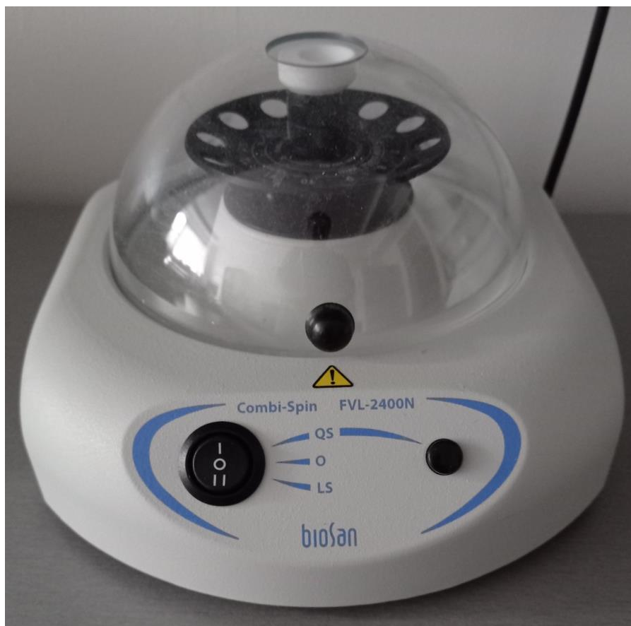
Рис. 2 Центрифуга-вортекс для підготовки зразків
