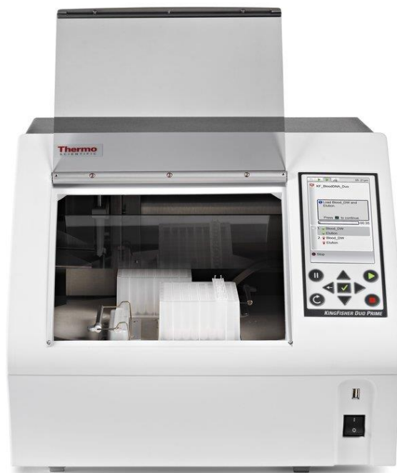
Рис. 3. Прилад для автоматичної екстракції нуклеїнових кислот за допомогою магнітних кульок «KingFisher Duo Prime» (Thermo Fisher, США)
