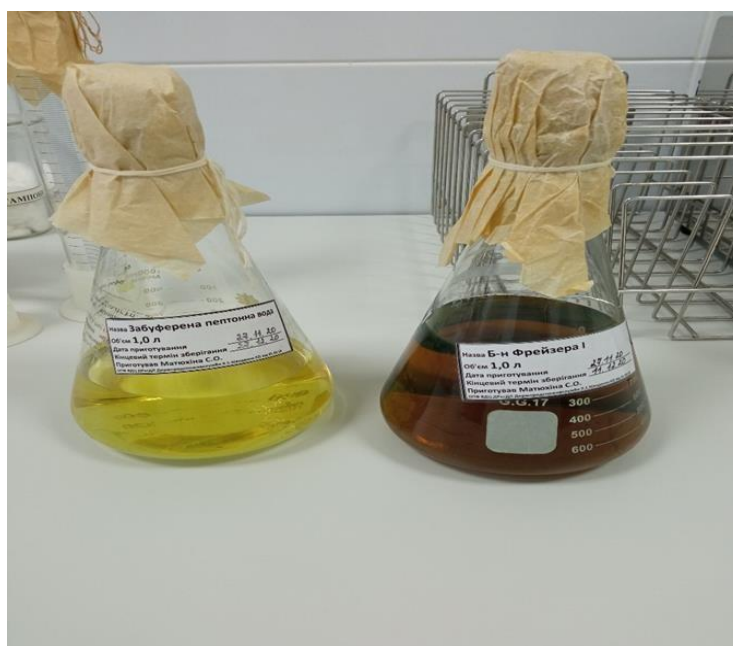
Рис. 9. Розчин Фрейзера та забуферена пептонна вода для підготовки проб до мікробіологічного дослідження
