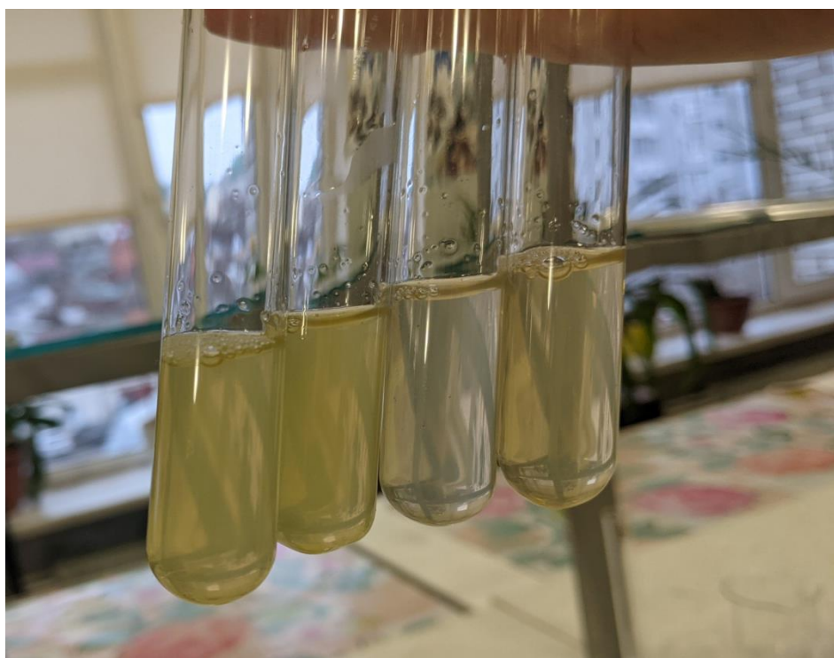
Рис. 13: Результат проведення дослідження на виявлення домішок желатину
