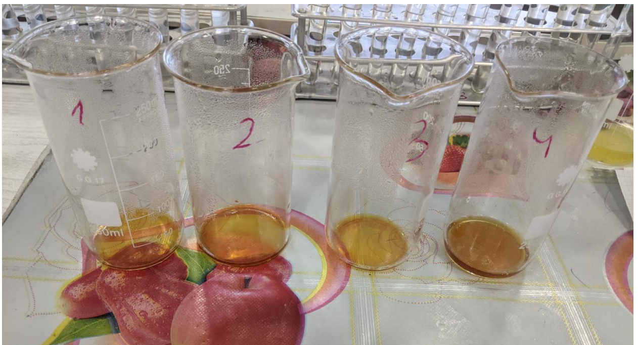
Рис. 21: Якісна реакція на наявність в пробах домішок крохмалю або борошна.
