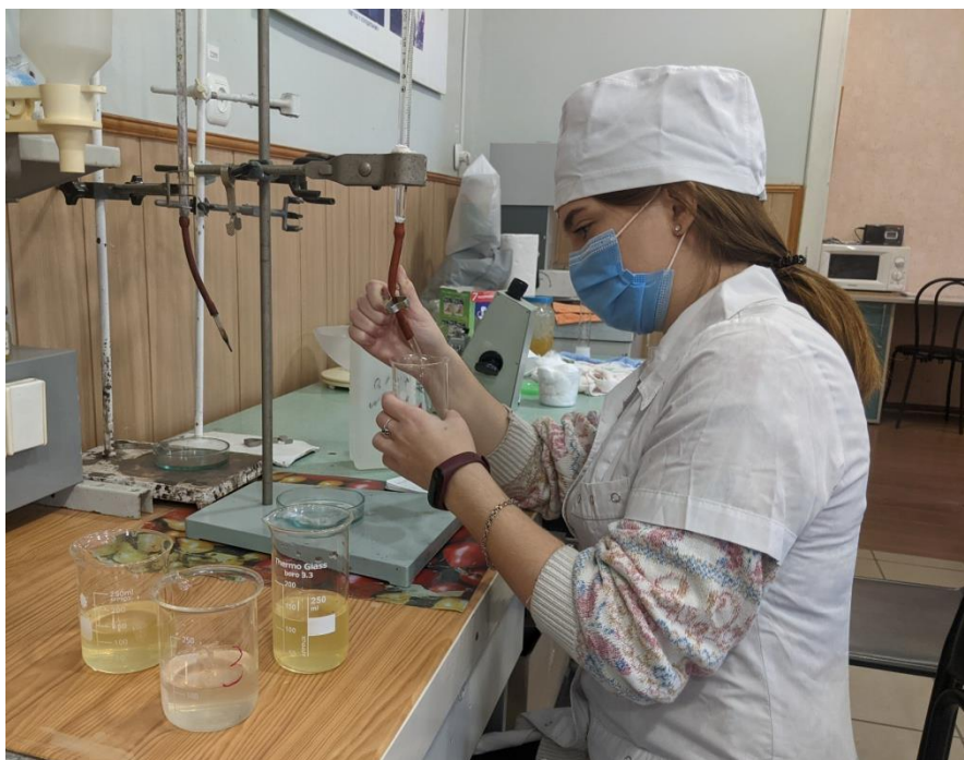
Рис. 8: Титрування 10% розчину меду 0,1 Н розчином NaOH.
