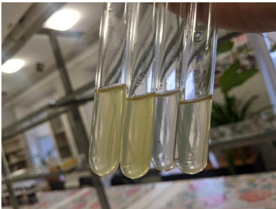
Рис. 12: Результат проведення спиртової реакції на наявність паді.
