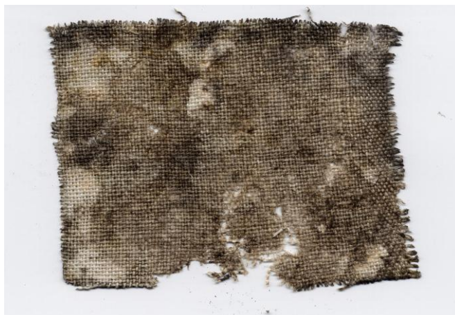
Руйнація льняного полотна при застосуванні дослідної технології, 17%
