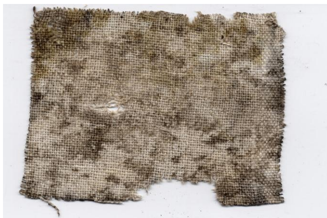
Руйнація льняного полотна при застосуванні дослідної технології, 10%
