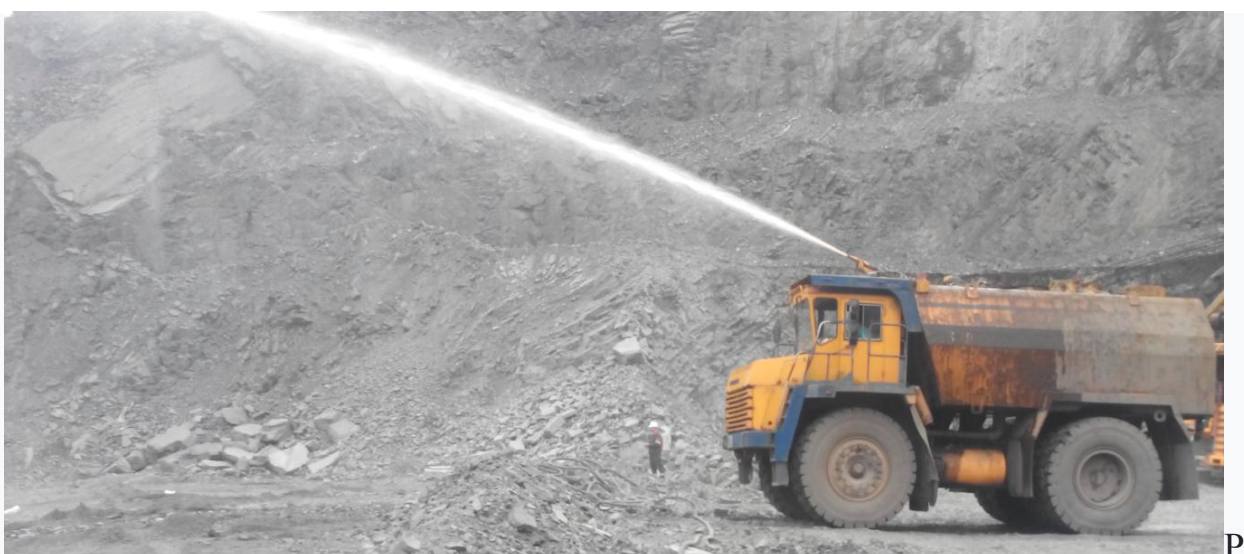
Рис.2. Нанесення водного розчину реагенту «Лексол» на поверхню заряду, блоку і прилегли уступи
