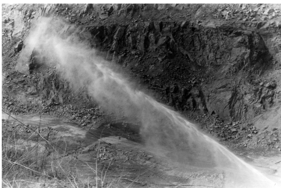
Рисунок.5- Випробування установки ІМДО-300 на кар'єрі КДЗ, процес розпаду водяного струменя з утворенням крапель
