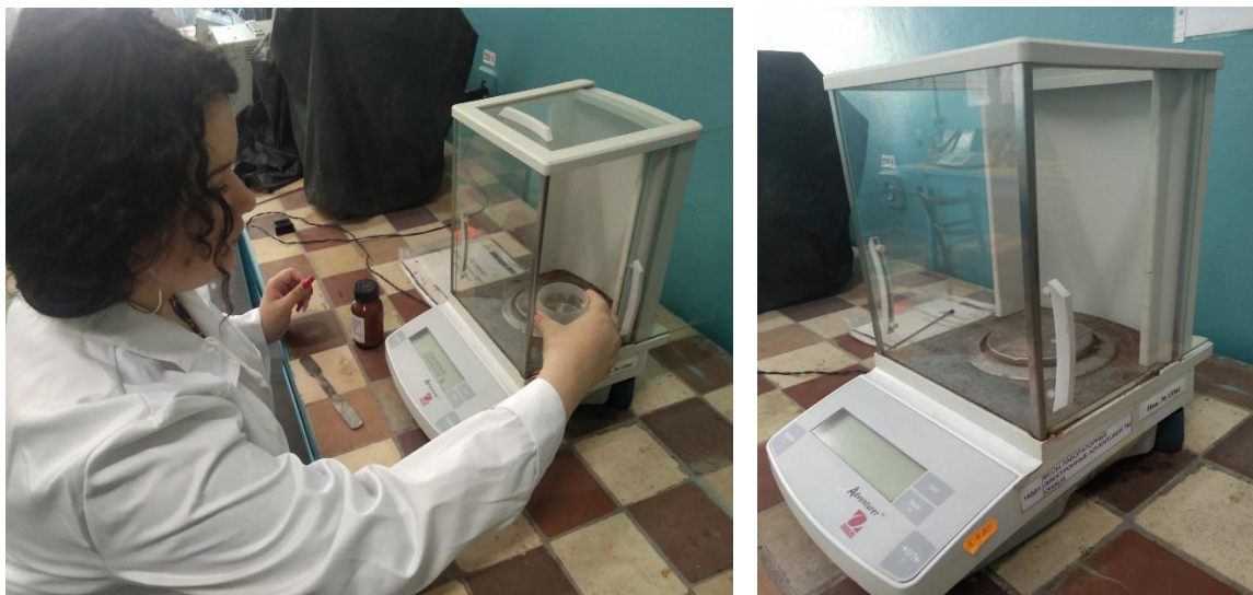
Рисунок 4.5 – Робота з лабораторними вагами AR 2140
