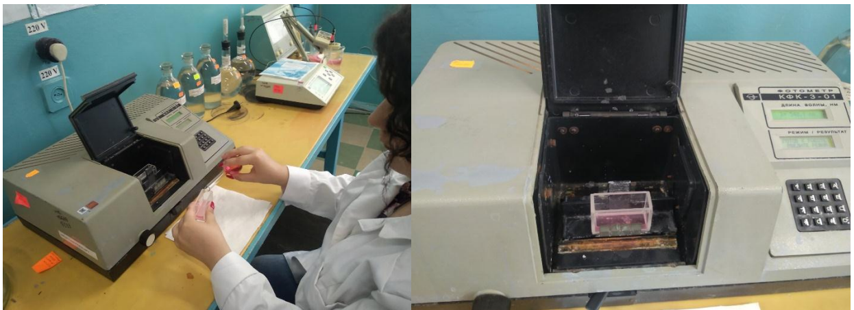
Рисунок 3.6 – Робота в лабораторії з Фотометром КФК 3-01
