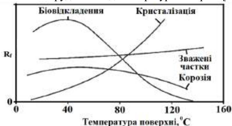
Рисунок 1. Температурна залежність для різних типів забруднення теплообмінників
