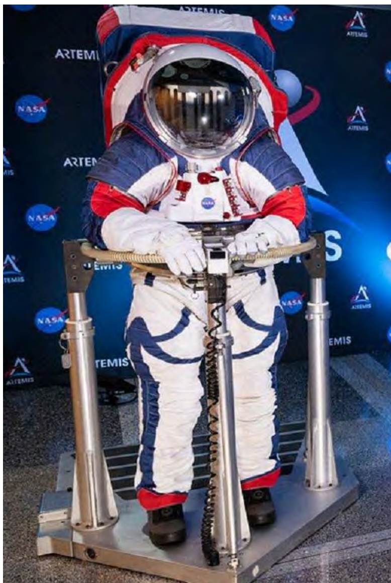
Рис. 10.11 – Скафандр xEMU для роботи на поверхні Марса чи Місяця.
