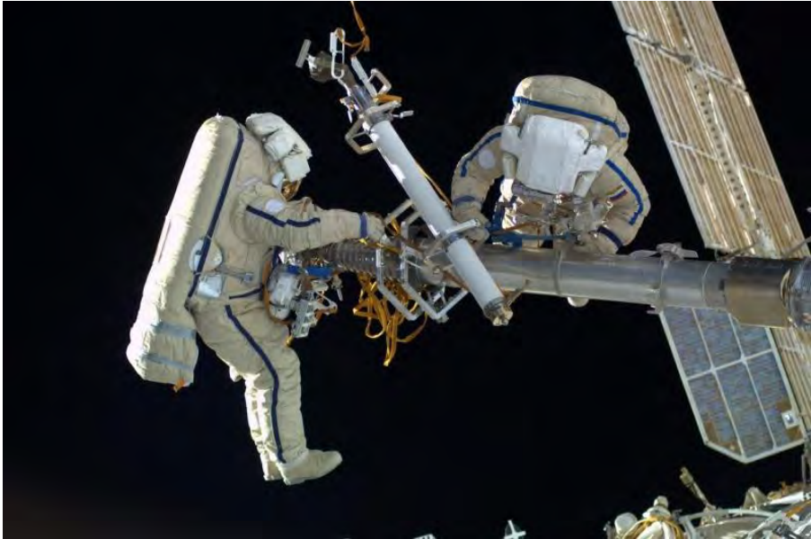
Рис. 10.8 – Скафандр «Орлан МКС» для роботи у відкритому космосі
