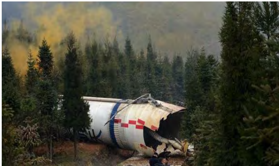
Рис. 3.2 – Падіння першого ступеня ракети китайського виробництва «Великий похід»: ступінь працювала на (НДМГ + АТ); помаранчева хмара на знімку – пари аміла, вкрай токсичні та канцерогенні.
