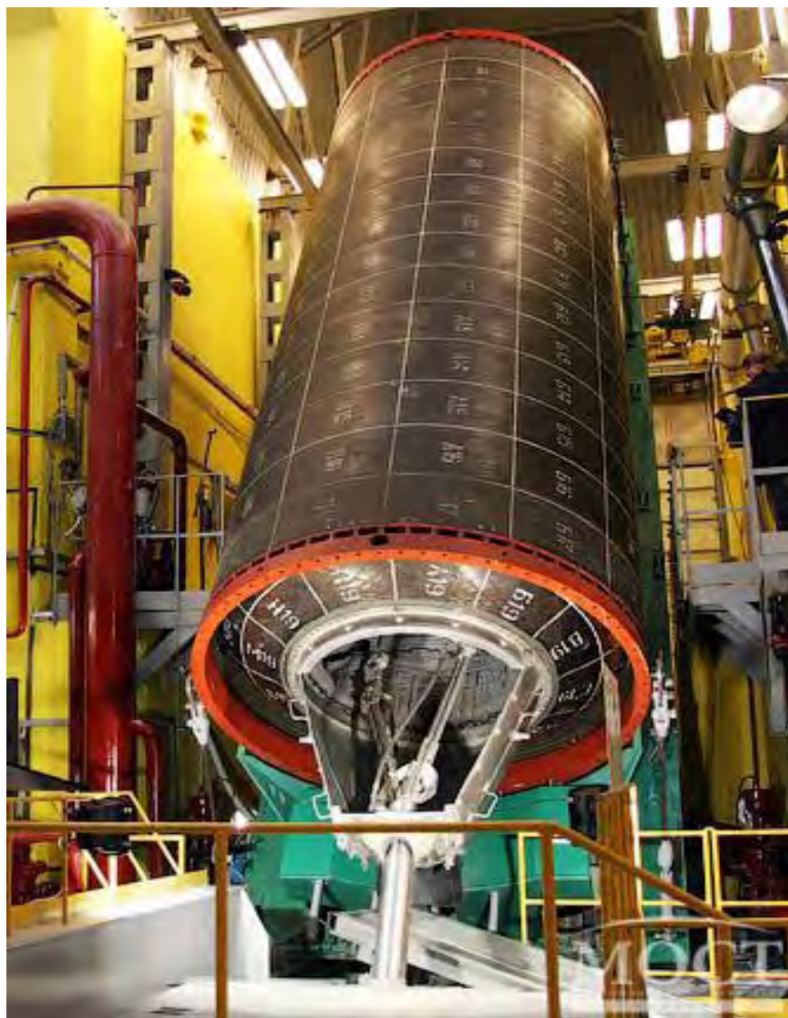
Рис. 3.4 – Комплекс обладнання для утилізації твердого ракетного палива на Державному підприємстві "Науково-виробниче об'єднання "Павлоградський хімічний завод", Україна
