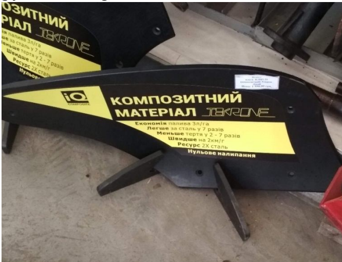
Рис. 1. Відвал плуга, виготовлений з високомолекулярної сполуки “TEKRONE”
