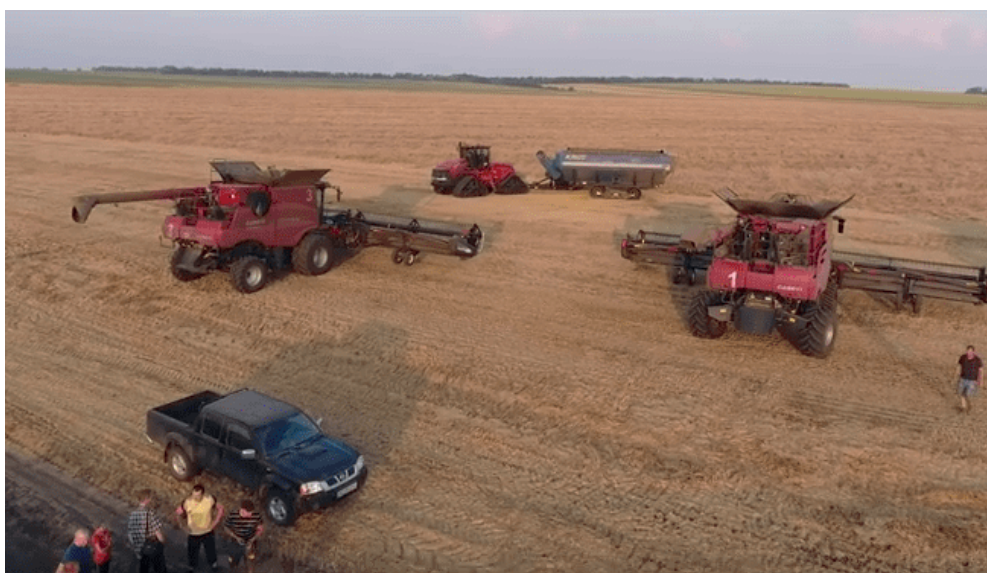
Рис. 4.2. Фрагмент виробничої ситуації на збиранні ранніх зернових колосових культур у ТОВ «Агро КМР» Павлоградського району Дніпропетровської області: комбайни Case 8120, оснащені широкозахватними жатками Mac Don FD 70; трактор Case STS 500 Quatrac, бункер-перевантажувач Kinze-1350
