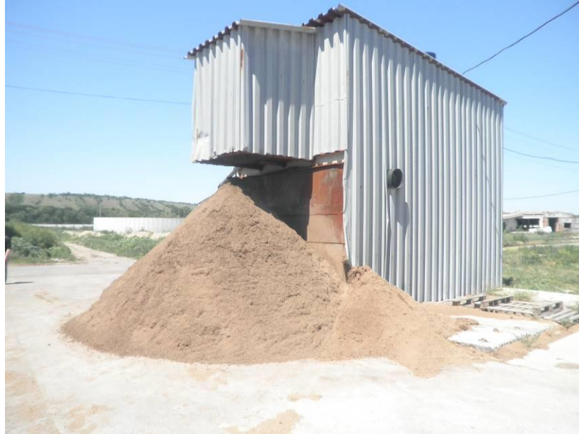
Рис. 11. Елемент біогазової установки з висушування твердих фракцій гною
