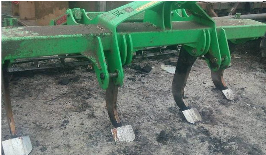
Рис.1.18 – Глибокорозпушувач з лопатовидними стояками і оригінальним механізмом переводу у транспортне положення.
