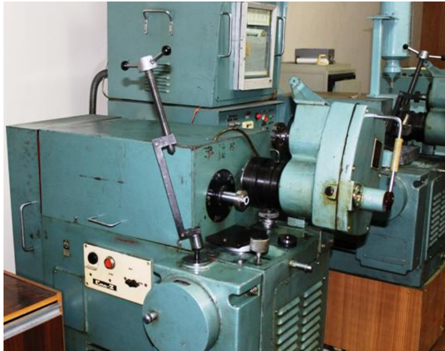
Рисунок 3.6 – Машина для дослідження тертя та зношування СМЦ-2
