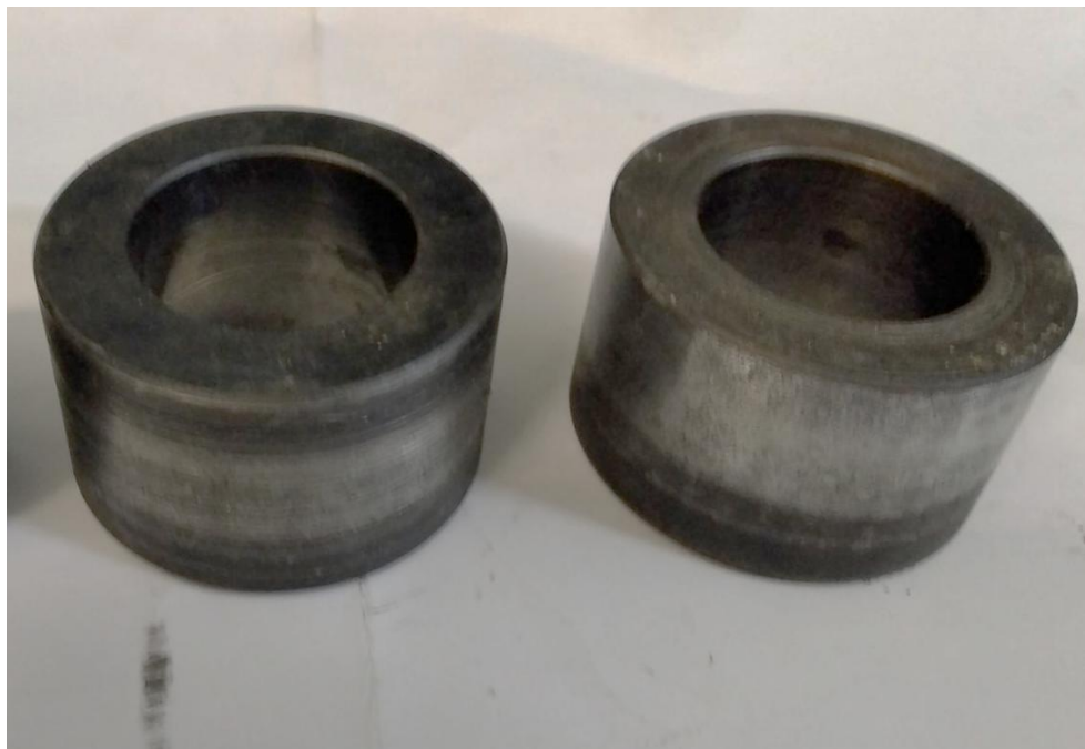
Рисунок 3.7 – Кільце-калібр для дослідження зносу деталей з композитних матеріалів
