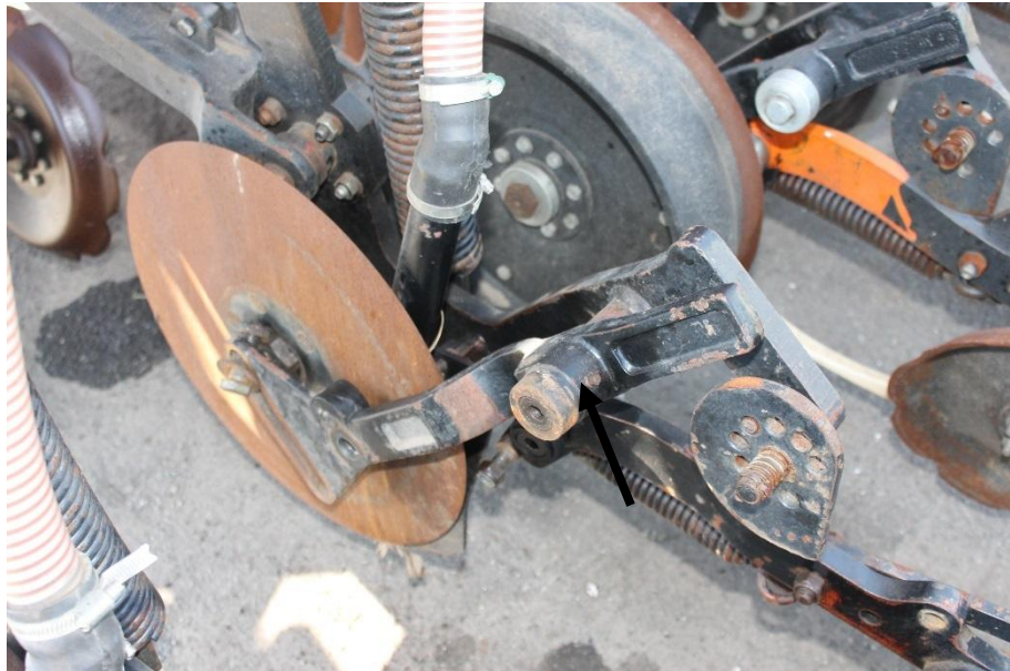
Рисунок 1.7 – Точки мащення трибоспряження з підшипником ковзання (стрілкою вказана точка обслуговування рухомого з'єднання опорного колеса посівної секції)
